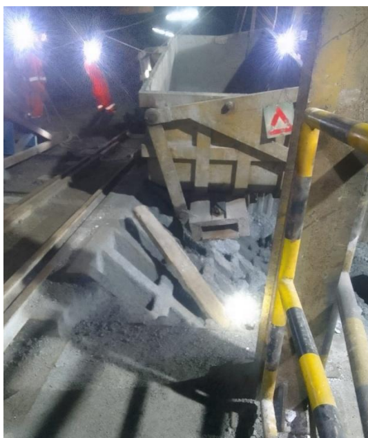
Figura 12. Descarrilamiento de camión
