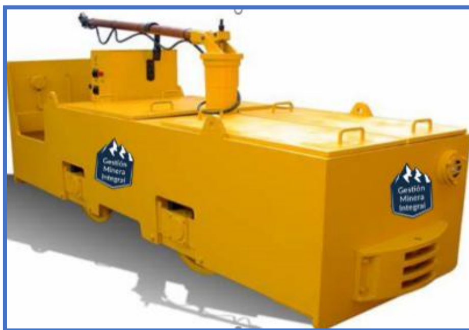
Figura 16. Locomotora de trolley Fuente: Tomada de GMI
