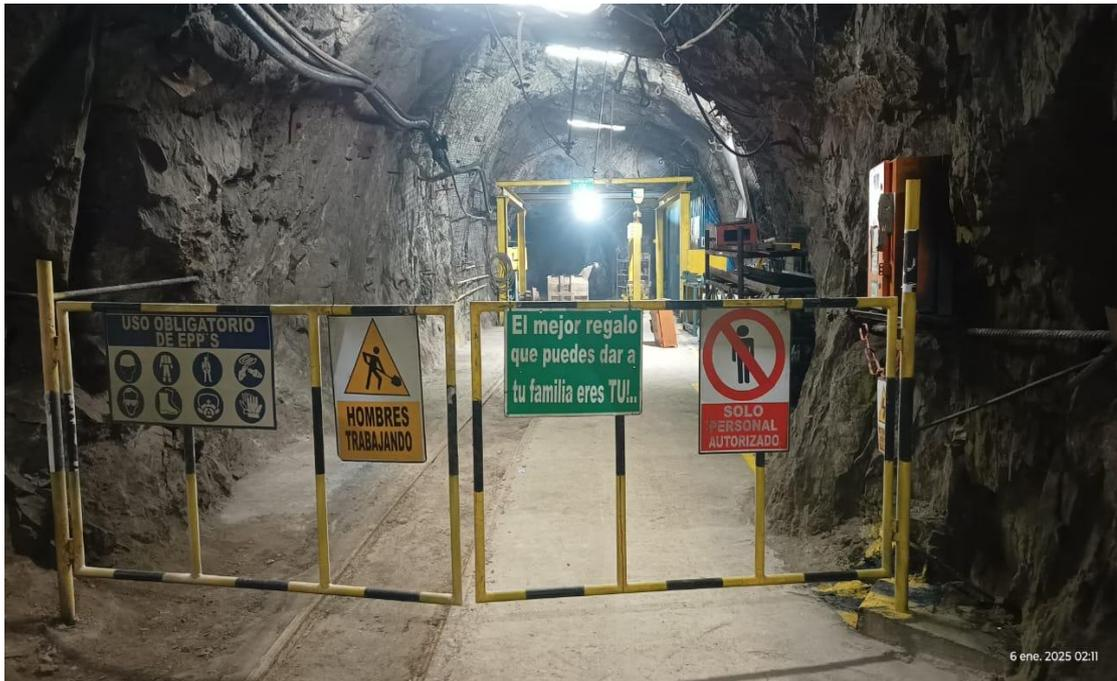
*Figura 42. Taller nivel 21 vetas implementado con letreros de seguridad y tablero de seccionador eléctrico para bloqueo de energía*
