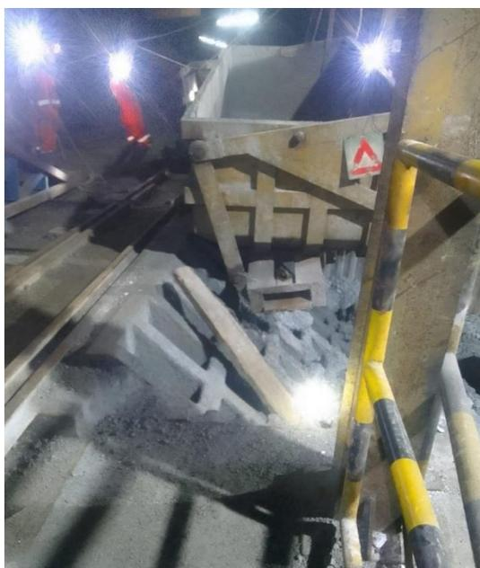
**Figura 12. Descarrilamiento de camión**
