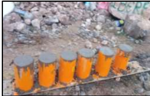
Figura 54. testigos de concreto del sobrecimiento reforzado.
