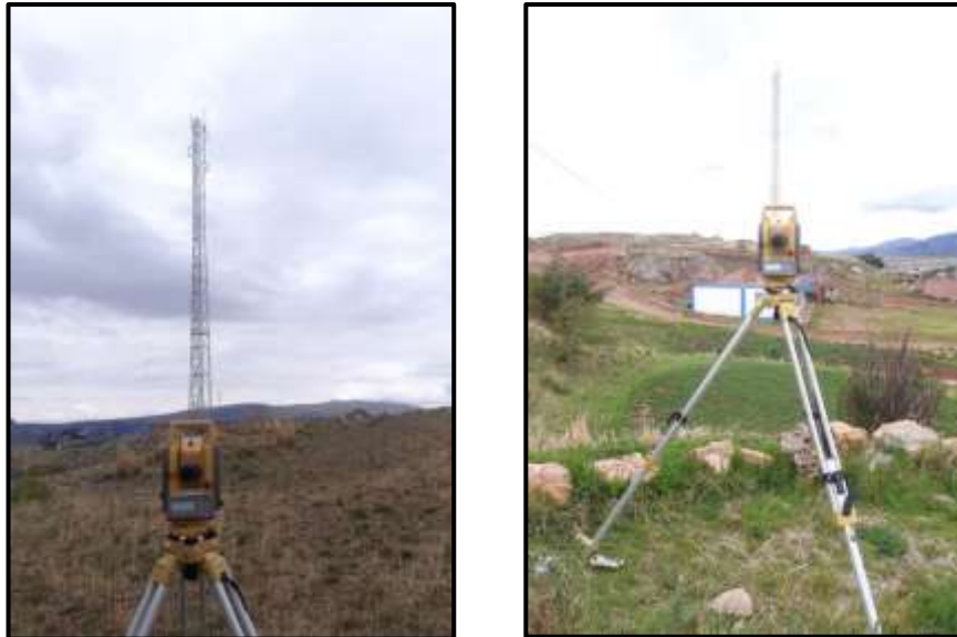
Figura 65 Verificación de los desplazamientos de la torre en dos puntos.
