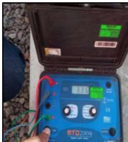
Figura 98. Medición de los pozos a tierra
