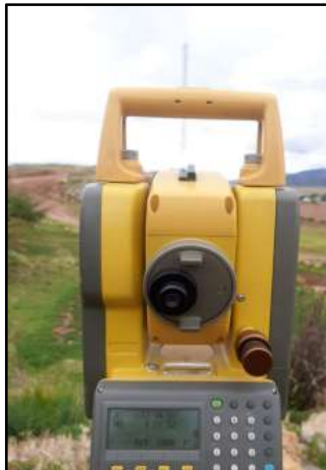
Figura 66. Verificación de los desplazamientos de la torre.
