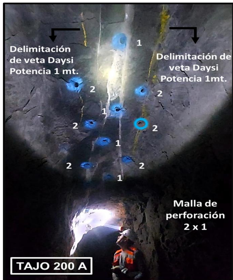
Malla de perforación 2 x 1 en la veta Daysi.
