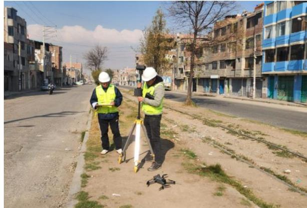
**Figura 50.** *Instalación de Equipos Mavic enterprise 3 RTK*
