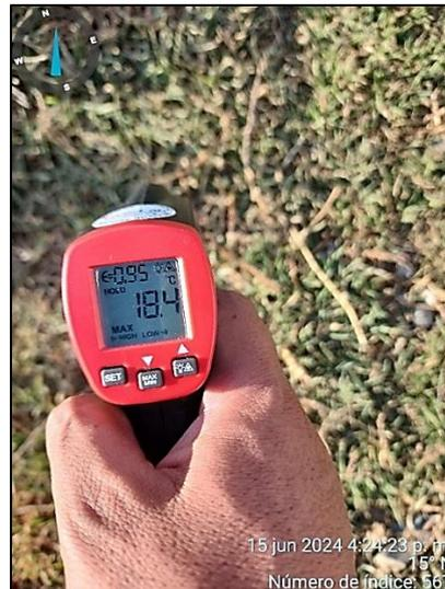
**Figura 44.** Pistola de calor infrarroja marca UNI-T modelo UT-300S
