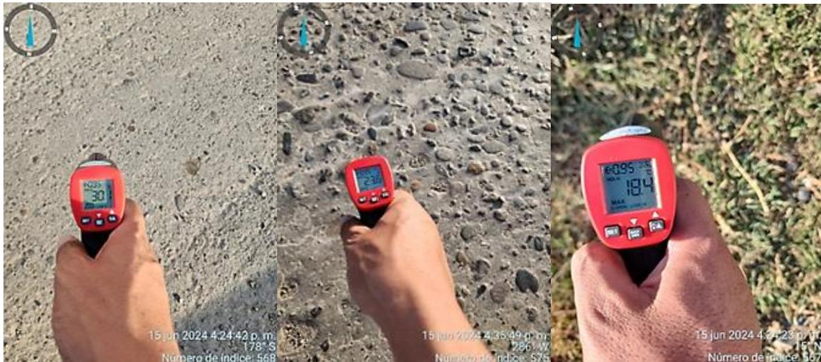
**Figura 40.** Lectura de temperatura con termómetro digital sobre pavimento rígido, flexible y área verde.
