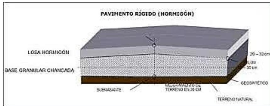
**Figura 11.** *Diseño de Pavimento rígido*
