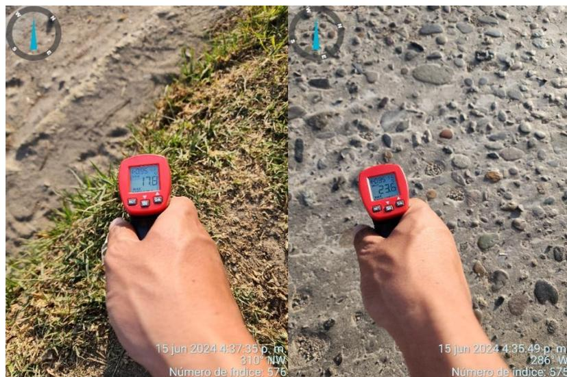
**Figura 60.** Toma de Muestra PV 02–Temperatura Pav. Flexible y Área verde (Hcyo-Centro)
