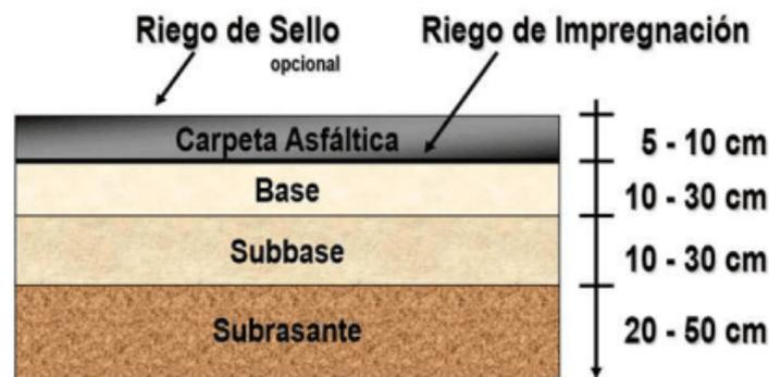
Figura 4. Estructura de pavimento flexible
