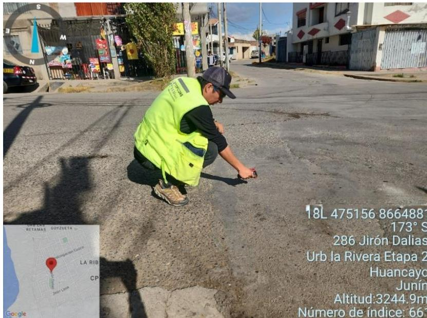
**Figura 73.** Toma de Muestra PV 13 –Temperatura Pavimento Flexible (Sector La Ribera)
