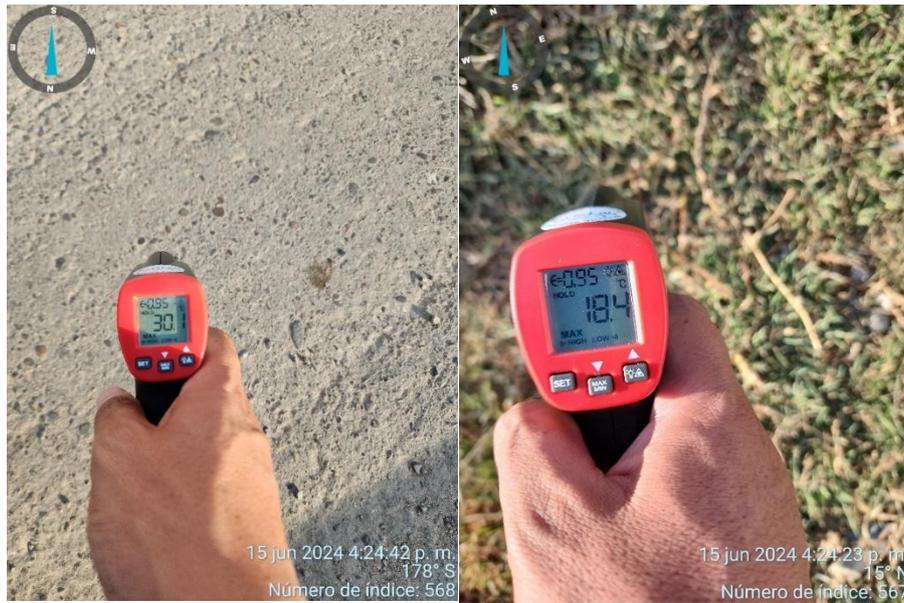
**Figura 59.** Toma de Muestra PV 01–Temperatura Pav. Flexible y Área verde (Hcyo-Centro)
