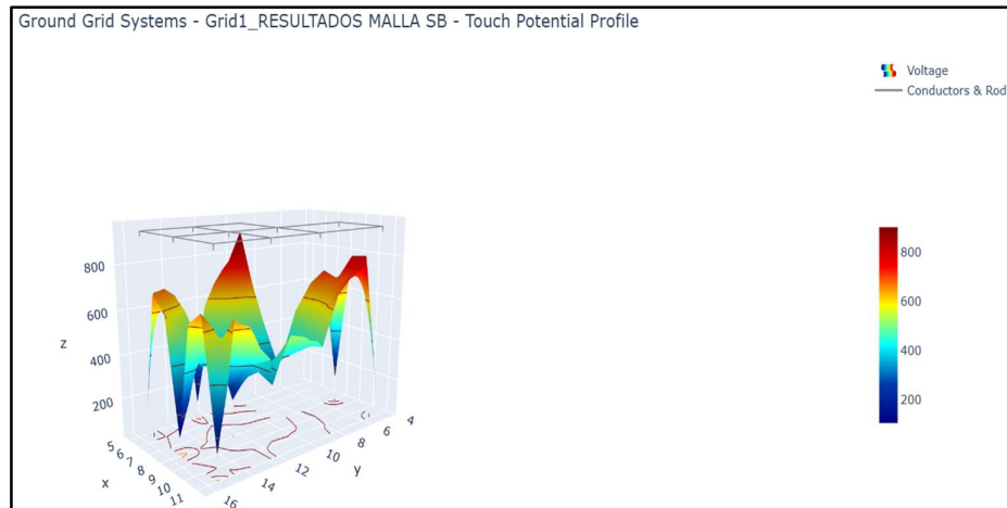
Figura 24. Simulación de la tensión de toque en la malla de puesta a tierra
