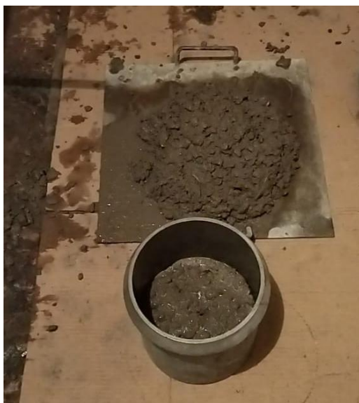
Figura N°1: Separación de concreto en estado fresco
