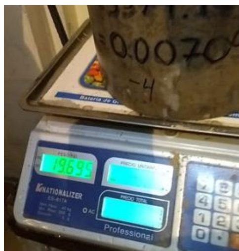
Figura N°6: Medición de olla Washington con concreto en estado fresco
