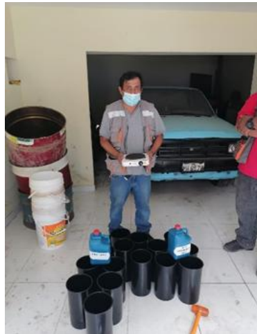
Figura N°1: Moldes para el curado del concreto
