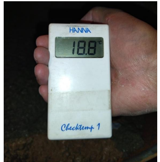
Figura N°4: Temperatura del concreto en estado fresco
