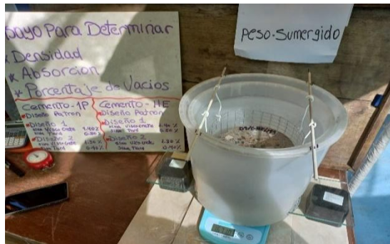
Figura N°5: Espécimen D1/C-HE/M3 sumergido Adaptación de balanza para peso sumergido
