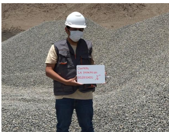
Figura N°5: Extracción de agregado grueso, piedra chancada de 1/2\"/>
