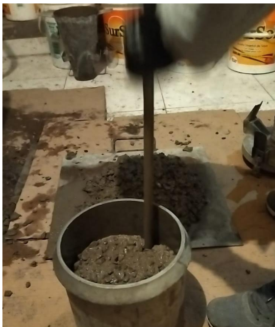
Figura N°3: Compactación con 25 inserciones con varilla lisa
