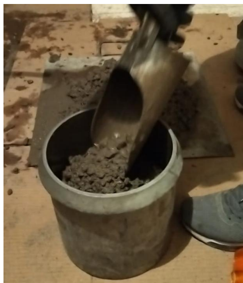
Figura N°2: Colocación de concreto en estado fresco en la olla
