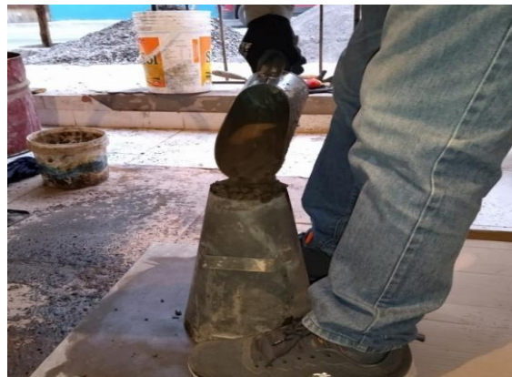
Figura N°2: Colocación de concreto fresco Cono de Abrams por capas
