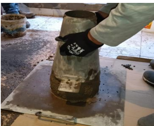
Figura N°5: Retiro de Cono de Abrams lentamente
