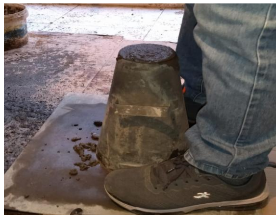
Figura N°4: Posicionamiento de cono de Abrams con las 03 capas de concreto
