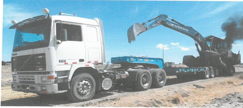
**IMAGEN N°01:** En la imagen se aprecia el montado de la maquinaria a la cama baja para su movilizacion a obra
