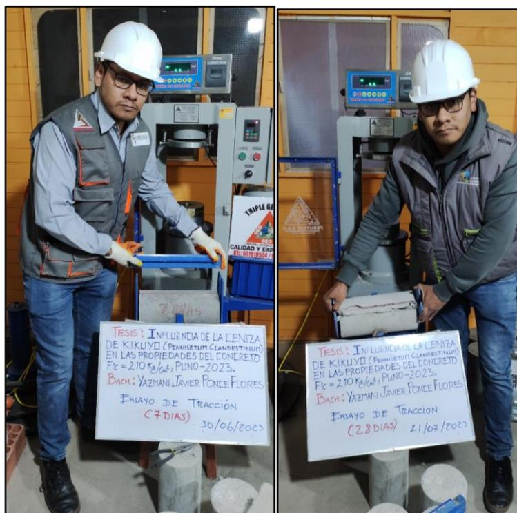
Valores resultantes del ensayo de resistencia del concreto sometido a tracción a los 7, 14 y 28 días de edad del curado con la adicción de ceniza de Kikuyo.
