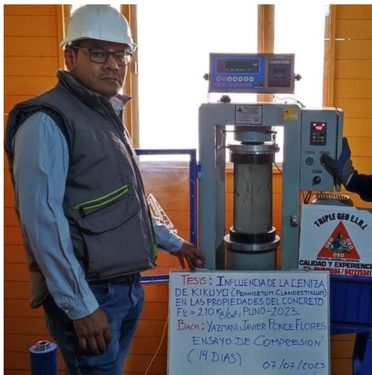
Se observo que en las fallas por compresión existía un patrón de similitud en las fallas a los 14 días que se obtuvo con una fuerza promedio de  $177.828 \text{ kgf/cm}^2$  resistencia a la compresión de dichas fallas resultantes al romperse los cilindros o briquetas se observó fallas tipos corte en su minoría y en su mayoría fallas tipo cono hendidura.
