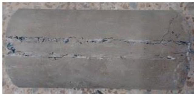
Se observo que durante la prueba de laboratorio de la resistencia del concreto sometida a tracción las fuerzas diametrales se distribuyen uniformemente en la tracción transversal a lo largo de su eje de carga causando una falla o rotura de la briqueta de manera repetitiva en la mayoría de los especímenes en estudio ya sea a las 7, 14 y 28 días de fraguado existiendo un patrón de similitud en las briquetas en el ensayo tracción.
