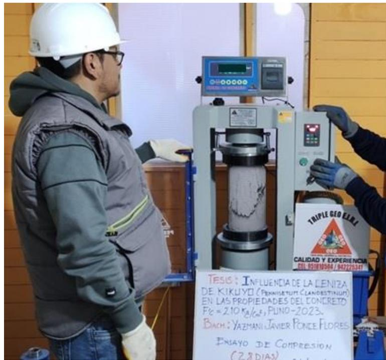
Se observo que en las fallas por compresión existía un patrón de similitud en las fallas a los 28 días que se obtuvo con una fuerza promedio de 232.083 kgf/cm<sup>2</sup> resistencia a la compresión de dichas fallas resultantes al romperse los cilindros o briquetas se observó fallas tipos corte en su minoría y las fallas más usuales que ocurrieron en su mayoría son las fallas tipo como hendidura.
