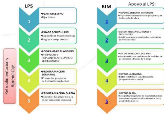
Figura 17. <sup>1</sup> Aplicación LPS y BIM
