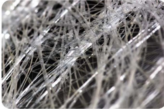
**Figura 3.** Vista microscópica de fibras de vidrio. Tomado de THE MACHADO ENVIRONMENTAL CORP.
