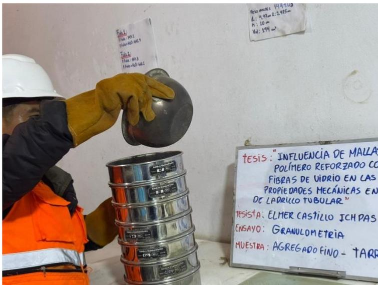
**Figura 99.** Granulometría de agregado fino para tarrajeo. Fuente: Elaboración propia.
