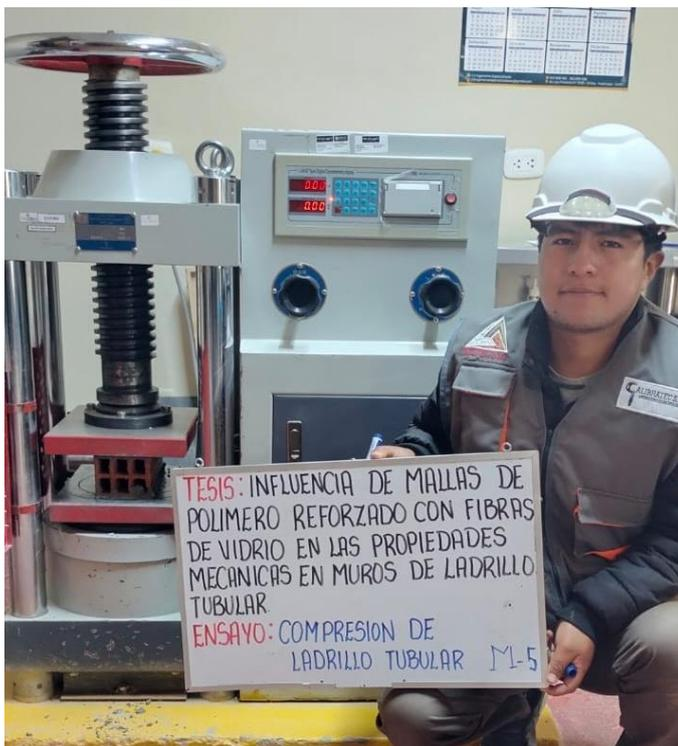
**Figura 73.** Ensayo de compresión de la muestra de ladrillo N.º 5. Fuente: Elaboración propia.
