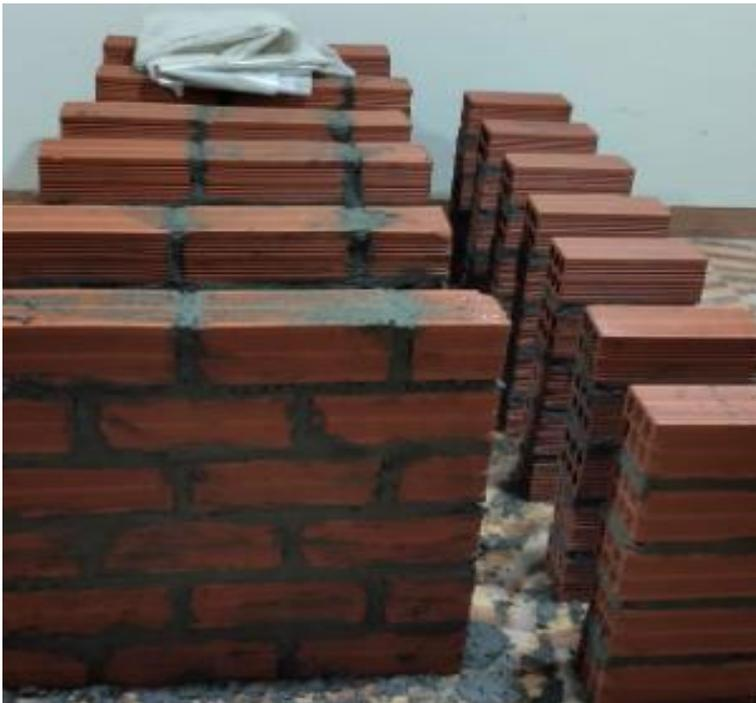
**Figura 87.** Total de pilas y muretes elaborados para la investigación. Fuente: Elaboración propia.
