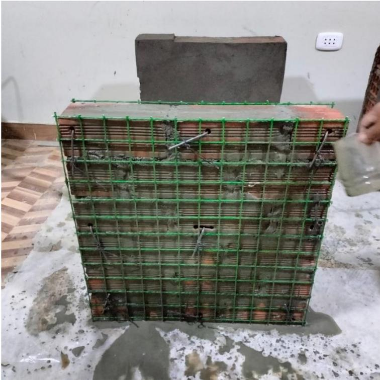
**Figura 90.** Lechada de cemento sobre la superficie del murete con GFRP para asegurar una correcta adherencia entre el murete y el mortero de tarrajeo. Fuente: Elaboración propia.
