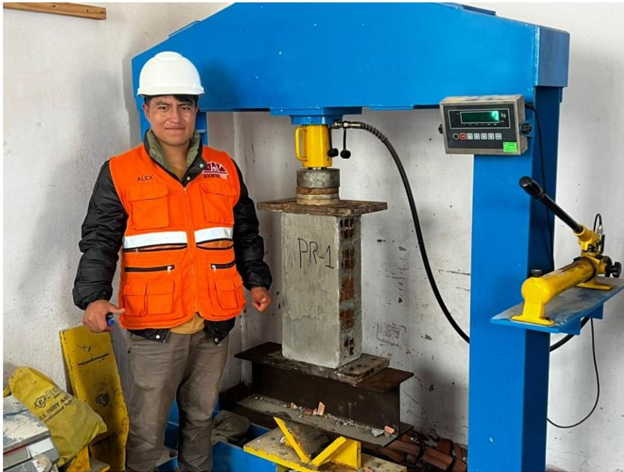
**Figura 104.** Ensayo de compresión de pila con refuerzo (PR-1) en Laboratorio GEOCONTROL PERÚ-Lima. Fuente: Elaboración propia.
