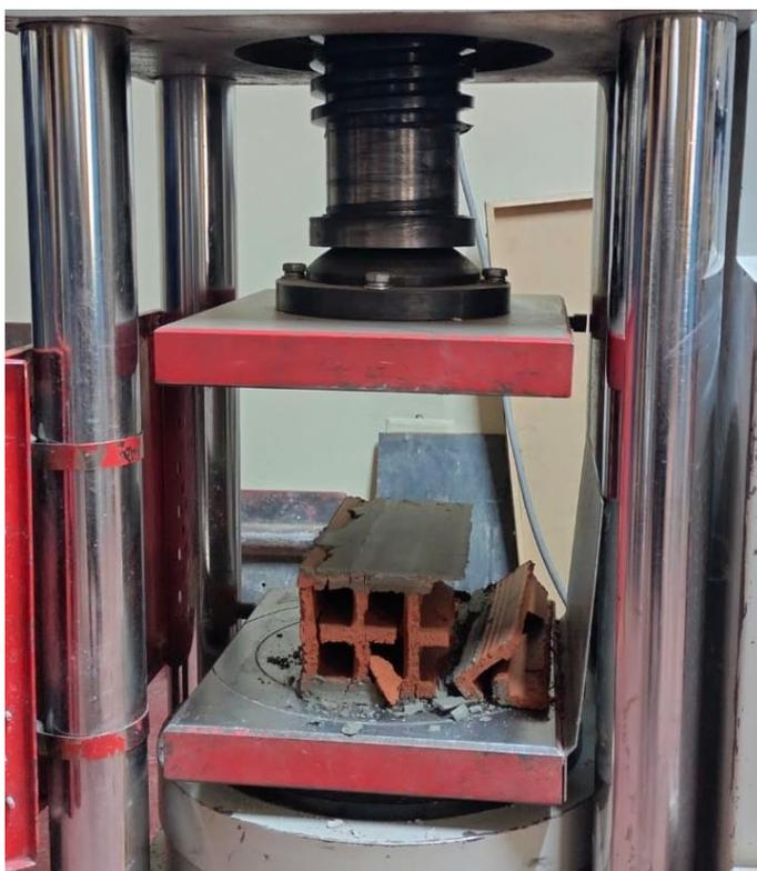
**Figura 74.** Fallas típicas presentadas durante el ensayo de compresión de ladrillo tubular. Fuente: Elaboración propia.
