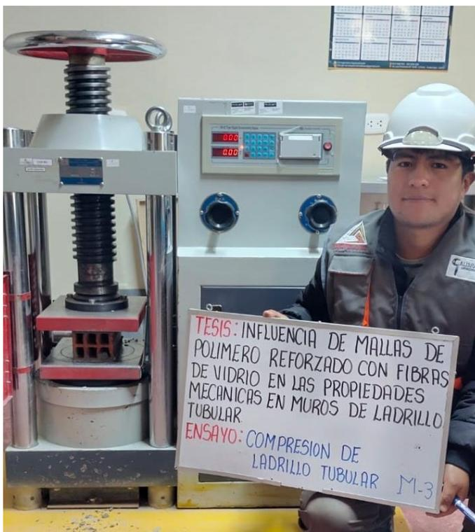
**Figura 71.** Ensayo de compresión de la muestra de ladrillo N.º 3. Fuente: Elaboración propia.
