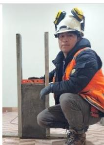
Y, por último, se aplicó un capping de 1 a 1,5 cm en la parte superior e inferior de la muestra, con el fin de garantizar una correcta aplicación de carga sobre la superficie, es decir, entre el cabezal del equipo (transcurrido los 28 días desde de haber finalizado la construcción de especímenes).
