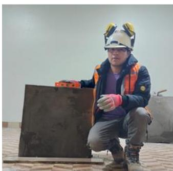
Y, por último, se aplicó un capping de 1 a 1,5 cm en la parte superior e inferior diagonal de la muestra, con el fin de garantizar una correcta aplicación de carga en la superficie diagonal (transcurrido los 28 días desde de haber finalizado la elaboración de los especímenes).
