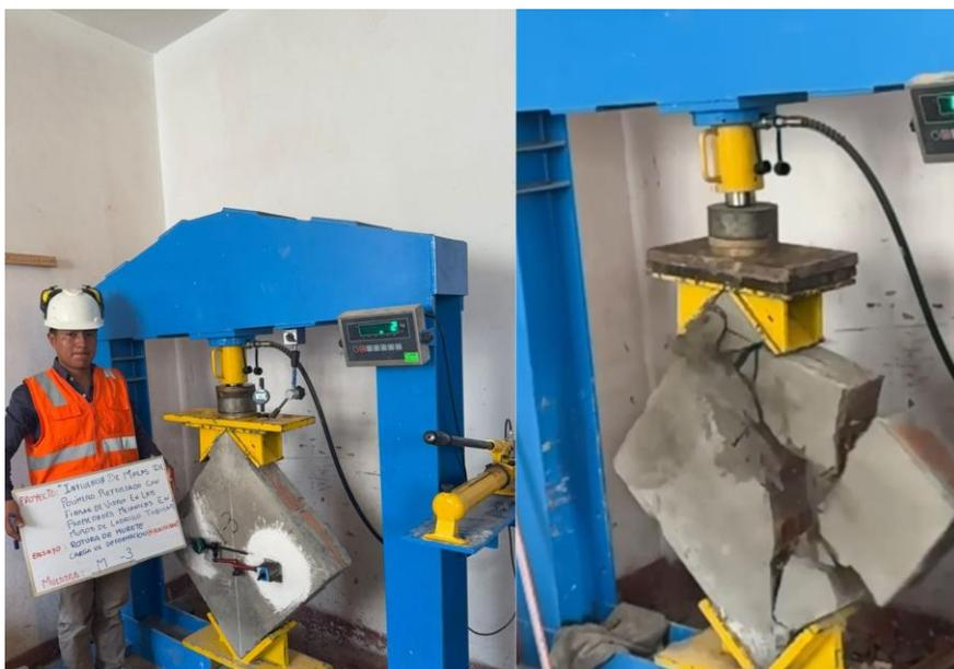
**Figura 109.** Ensayo de compresión diagonal en murete sin refuerzo (M-3) en Laboratorio GEOCONTROL PERÚ-Lima. Fuente: Elaboración propia.
