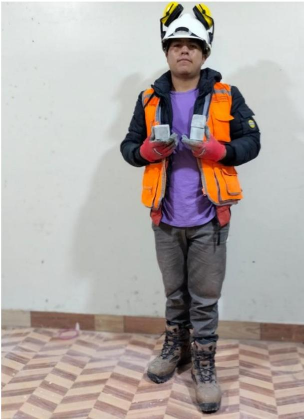
**Figura 93.** Probetas cúbicas de mortero para asentado de ladrillo de 5 cm de lado. Fuente: Elaboración propia.
