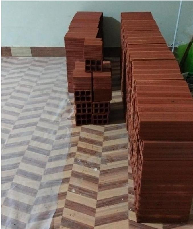
**Figura 76.** Ambiente preparado con materiales y herramientas listos para el asentado de pilas y muretes. Fuente: Elaboración propia.
