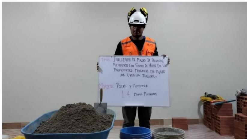
**Figura 15.** Materiales para realizar mortero de muros portantes en una proporción de 1:4. Fuente: Elaboración propia.
