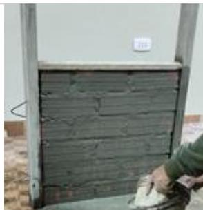
Quinto, transcurrido 14 días desde la construcción de las pilas, se procedió a humedecerlas con agua. Posteriormente, se aplicó lechada de cemento para garantizar una buena adherencia entre la superficie.
