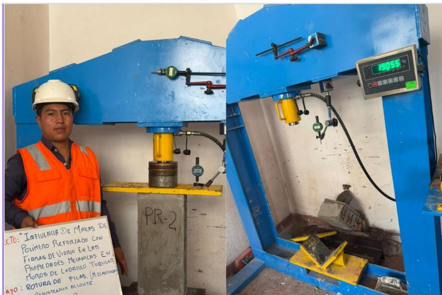
**Figura 105.** Ensayo de compresión de pila con refuerzo (PR-2) en Laboratorio GEOCONTROL PERÚ-Lima. Fuente: Elaboración propia.
