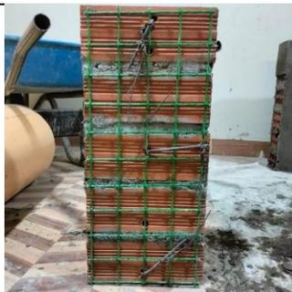
Transcurridos catorce días, se instalaron mallas de GFRP en ambos lados de la pila y se empotraron dos conectores de acero de grado 60 de 6 mm de diámetro a intervalos de 30 cm. A continuación, se humedeció toda la superficie con
