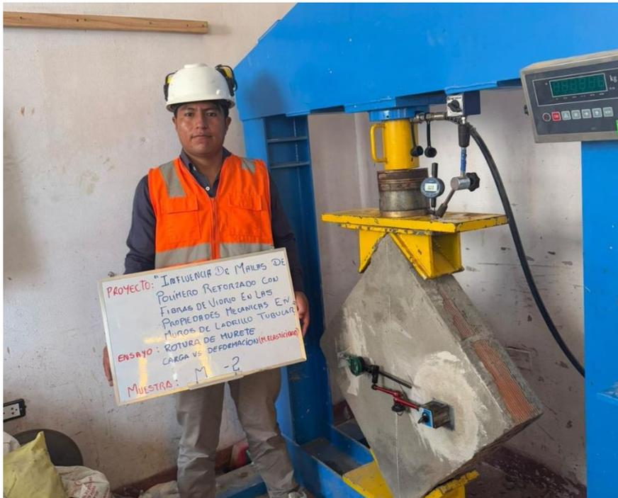
**Figura 108.** Ensayo de compresión diagonal en murete sin refuerzo (M-2) en Laboratorio GEOCONTROL PERÚ-Lima. Fuente: Elaboración propia.
