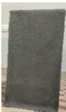
Cuarto, transcurrido catorce días desde la construcción de las pilas, se procedió a humedecerlas con agua, tras lo cual se aplicó una lechada de cemento para promover una adherencia eficaz. Posteriormente, se aplicó una capa de mortero en ambas caras de la muestra.
