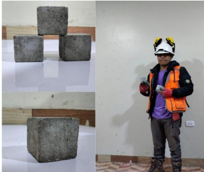
**Figura 17.** Probetas cúbicas de mortero, cada una con 5 cm de lado, se curaron durante 28 días en un baño de agua. Fuente: Elaboración propia.
