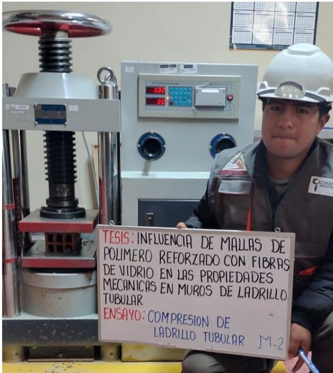
**Figura 70.** Ensayo de compresión de la muestra de ladrillo N.º 2. Fuente: Elaboración propia
