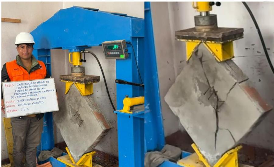
**Figura 107.** Ensayo de compresión diagonal en murete sin refuerzo (M-1) en Laboratorio GEOCONTROL PERÚ-Lima. Fuente: Elaboración propia.
