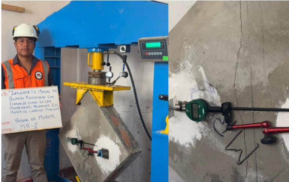
**Figura 110.** Ensayo de compresión diagonal en muretes con refuerzo (MR-1 y MR-2) en Laboratorio GEOCONTROL PERÚ-Lima. Fuente: Elaboración propia.
