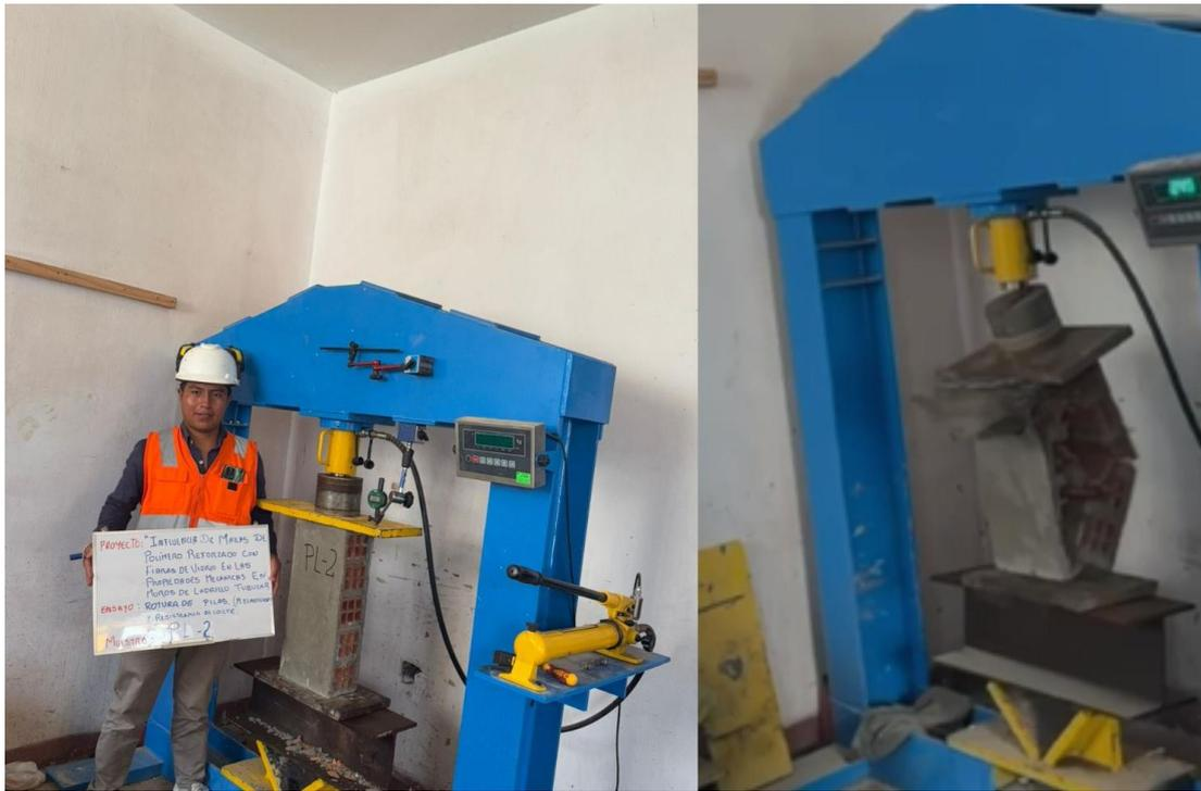
**Figura 102.** Ensayo de compresión de pila sin refuerzo (PL-2) en Laboratorio GEOCONTROL PERÚ-Lima. Fuente: Elaboración propia.
