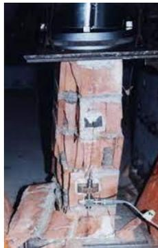
**Figura 21.** Trituración de ladrillos huecos. Fuente: Comentario de la norma e.070 Albañilería.
