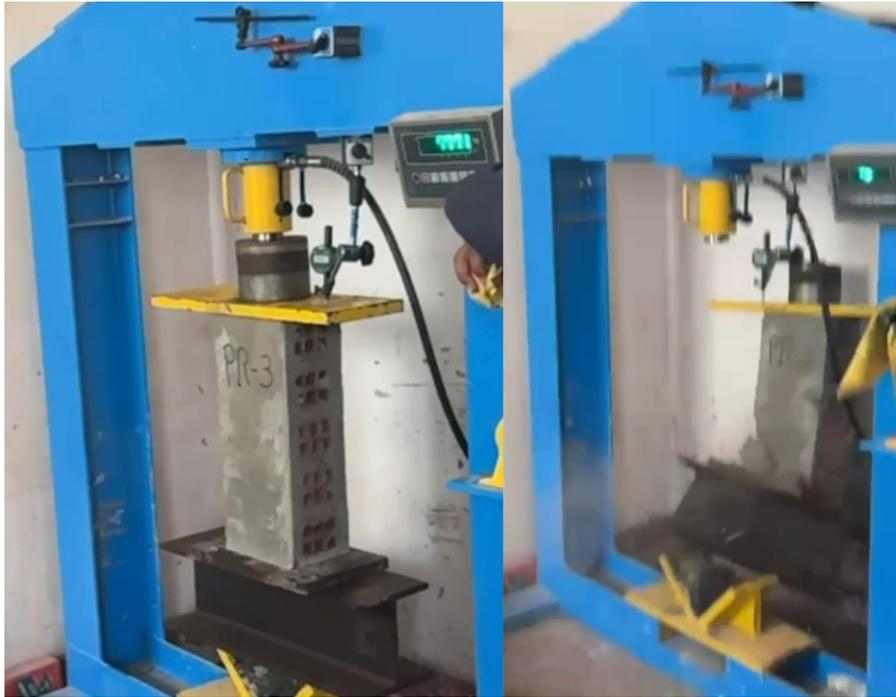
**Figura 106.** Ensayo de compresión de pila con refuerzo (PR-3) en Laboratorio GEOCONTROL PERÚ-Lima. Fuente: Elaboración propia.
