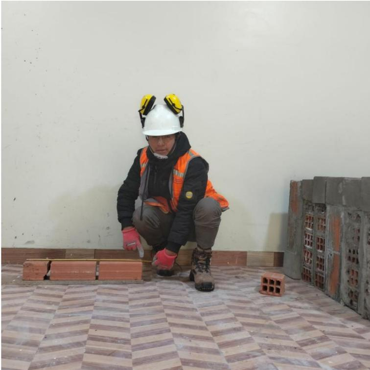
**Figura 84.** Base de madera empleada para la construcción de muretes de ladrillo tubular durante la fase experimental. Fuente: Elaboración propia.
