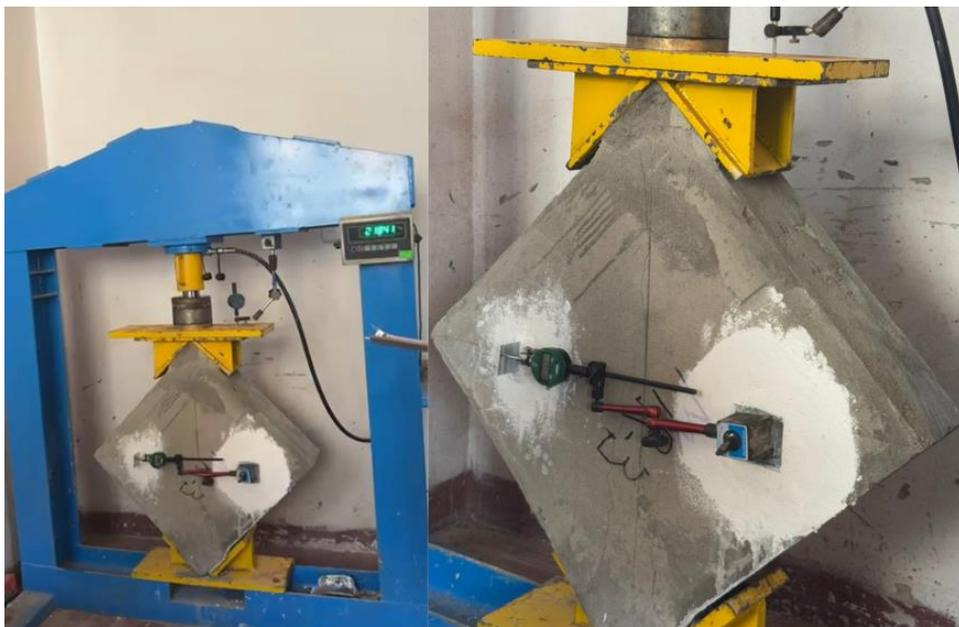
**Figura 111.** Ensayo de compresión diagonal en muretes con refuerzo (MR-3) en Laboratorio GEOCONTROL PERÚ-Lima. Fuente: Elaboración propia.
