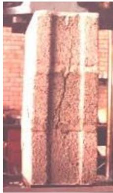
**Figura 20.** Falla ideal de pila. Fuente: Comentario de la norma e.070 ALBAÑILERÍA.
