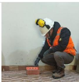
Segundo, se comprobó que la superficie estuviera plana y limpia, asegurándose de que estuviera nivelada, en ambas direcciones. Luego se colocaron las unidades de albañilería encima de una madera.
