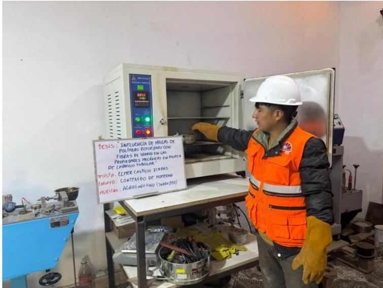
**Figura 98.** Contenido de humedad de agregado fino para tarrajeo. Fuente: Elaboración propia.
