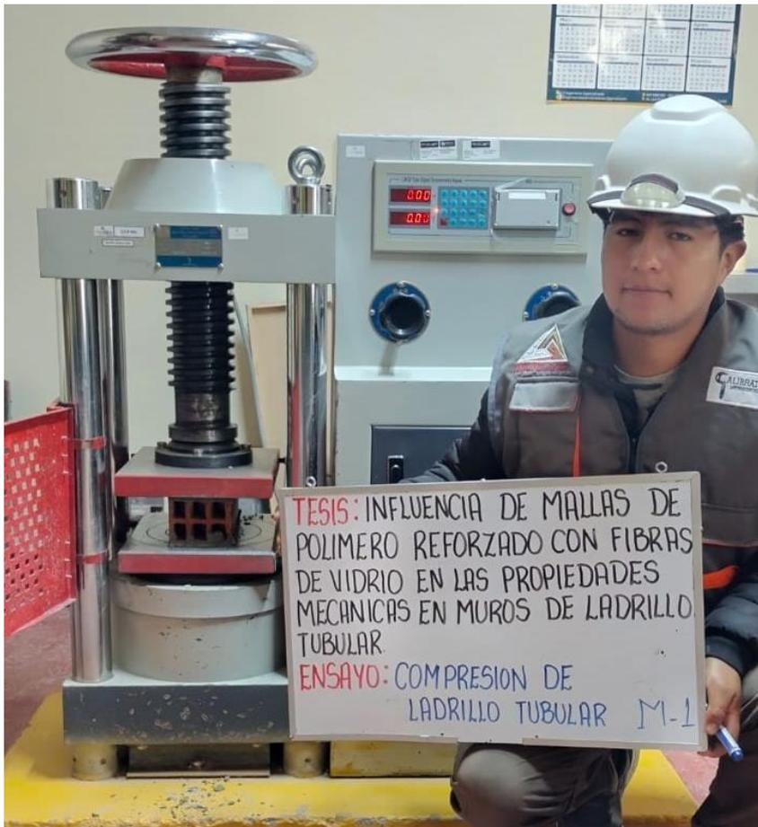
**Figura 69.** Ensayo de compresión de la muestra de ladrillo N.º 1. *Fuente:* Elaboración propia.
