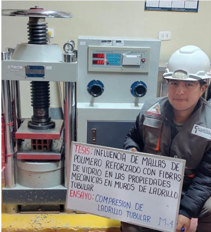
**Figura 72.** Ensayo de compresión de la muestra de ladrillo N.º 4. Fuente: Elaboración propia.
