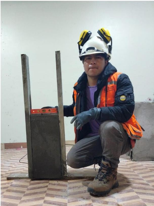
**Figura 83.** Pila de albañilería tubular con tarrajeo. Fuente: Elaboración propia
