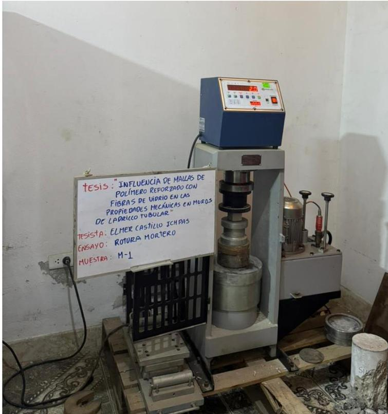
**Figura 100.** Rotura de morteros para asentado de ladrillo. Fuente: Elaboración propia.
