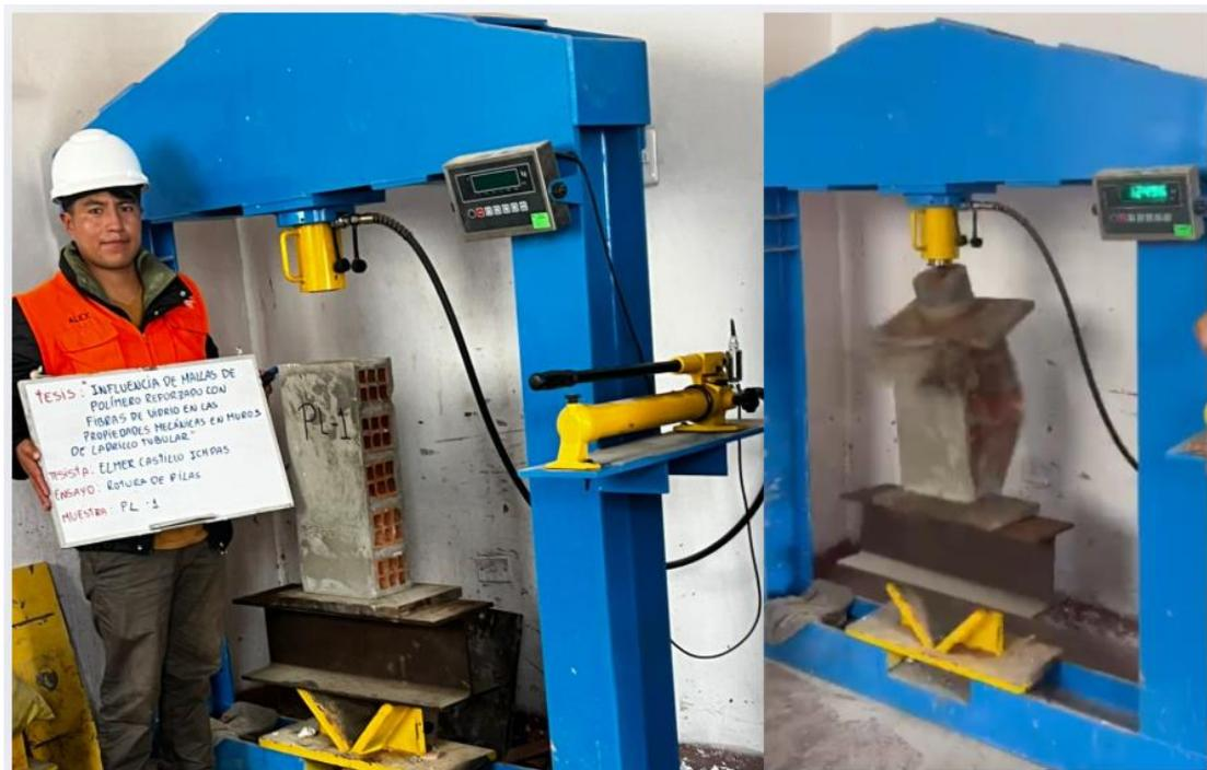
**Figura 101.** Ensayo de compresión de pila sin refuerzo (PL-1) en Laboratorio GEOCONTROL PERÚ-Lima. Fuente: Elaboración propia.
