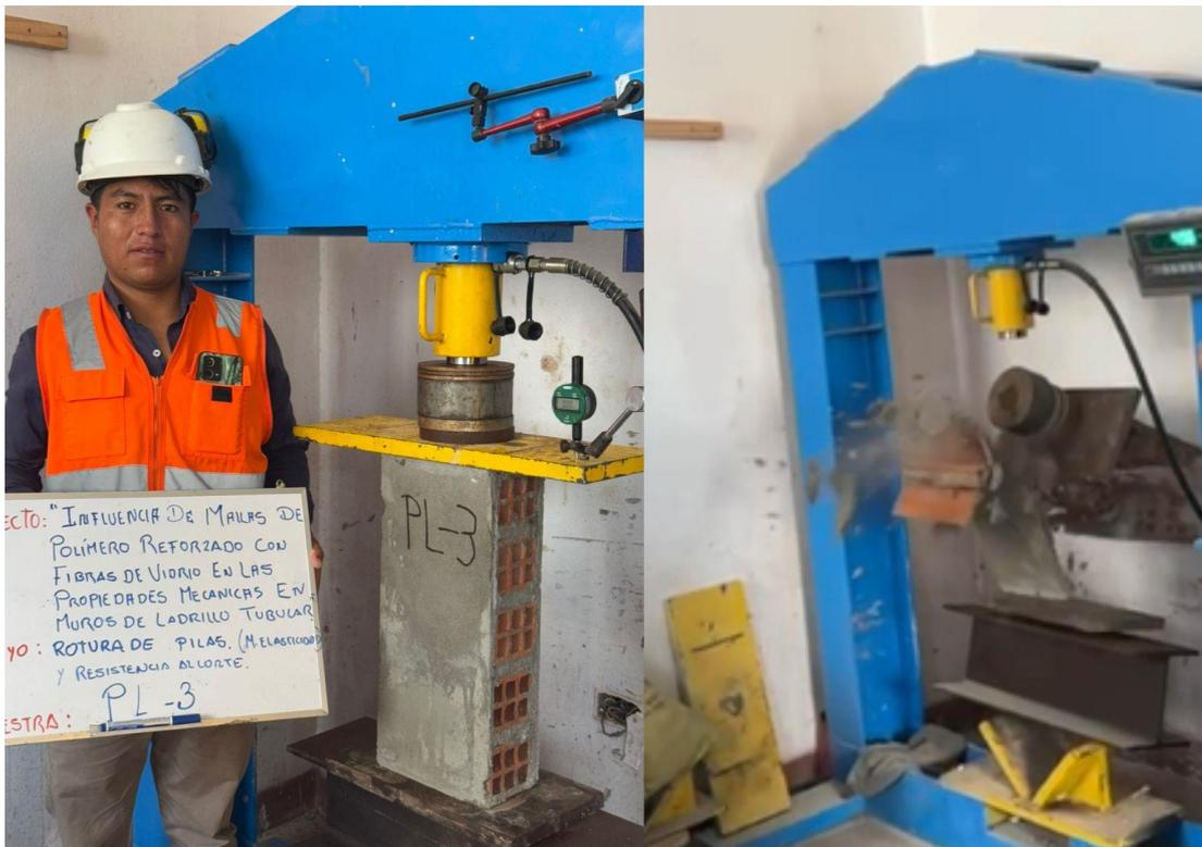
**Figura 103.** Ensayo de compresión de pila sin refuerzo (PL-3) en Laboratorio GEOCONTROL PERÚ-Lima. Fuente: Elaboración propia.
