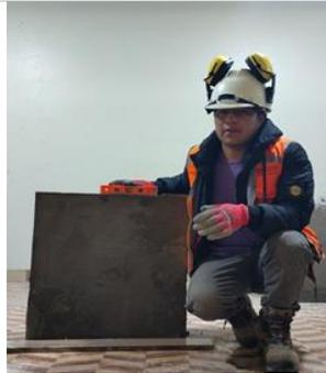
Y, por último, se aplicó un capping de 1 a 1,5 cm en la parte superior e inferior diagonal de la muestra, con el fin de garantizar una correcta aplicación de carga en la superficie diagonal (transcurrido los 28 días desde de haber finalizado la elaboración de los especímenes).
