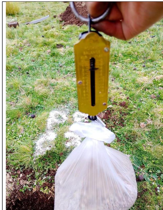
Fotografía 8: Medición del peso de la muestra de suelo.
