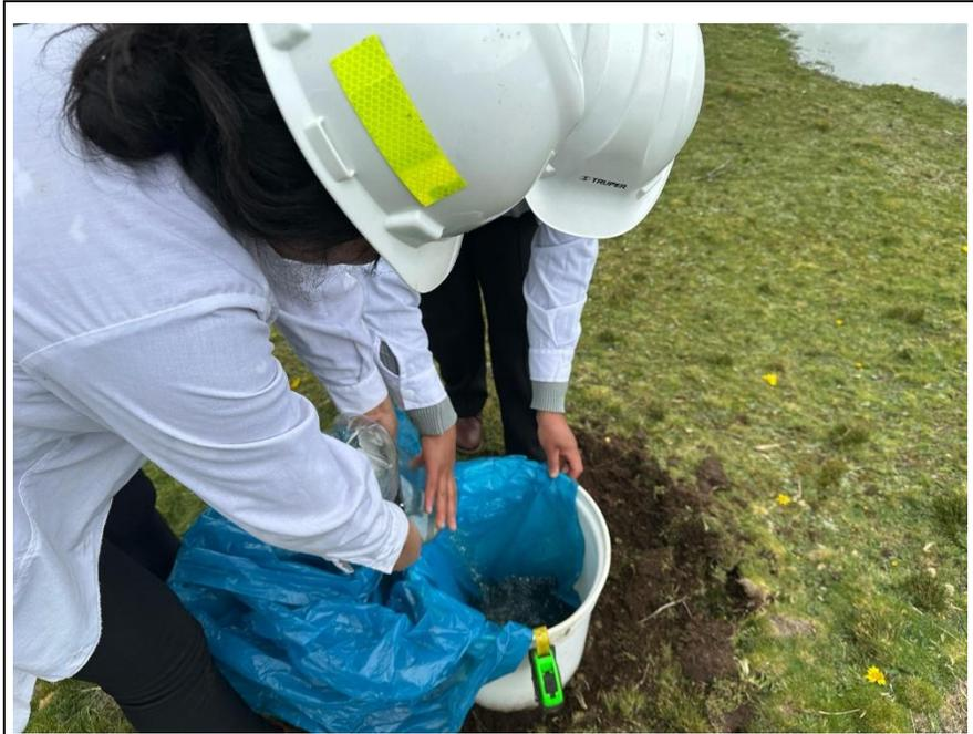
Fotografía 9: Preparación de la muestra de suelo para análisis de infiltración.
