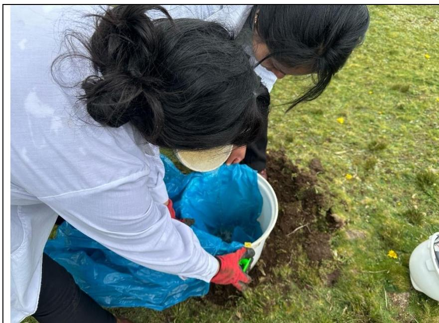
Fotografía 12: Acondicionamiento de la muestra de suelo para ensayo de infiltración
