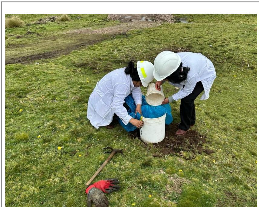
Fotografía 11: Vertido de agua en el ensayo de infiltración de suelos.
