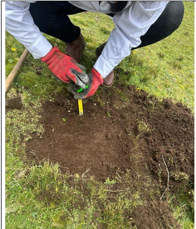
Fotografía 16: Excavación para toma de las muestras.
