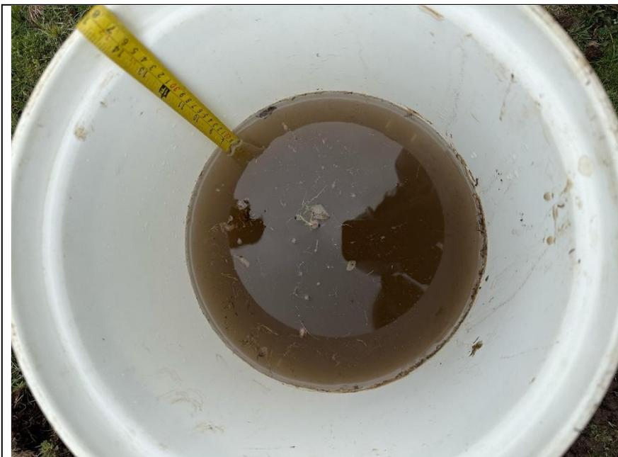
Fotografía 10: Medición del nivel de agua en ensayo de infiltración.
