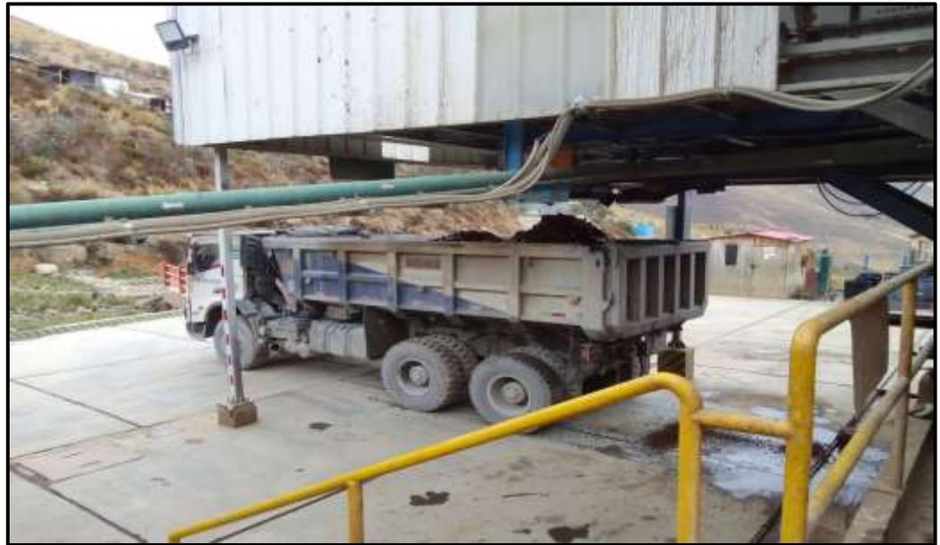
**Figura 17.** Proceso de descarga final del lodo seco hacia el volquete para su disposición final
