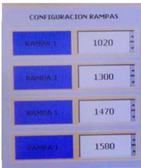
En esta ventana podemos configurar las velocidades de las rampas del motor de alimentación teniendo siempre en cuenta que la velocidad máxima del motor es de 1760RPM.
