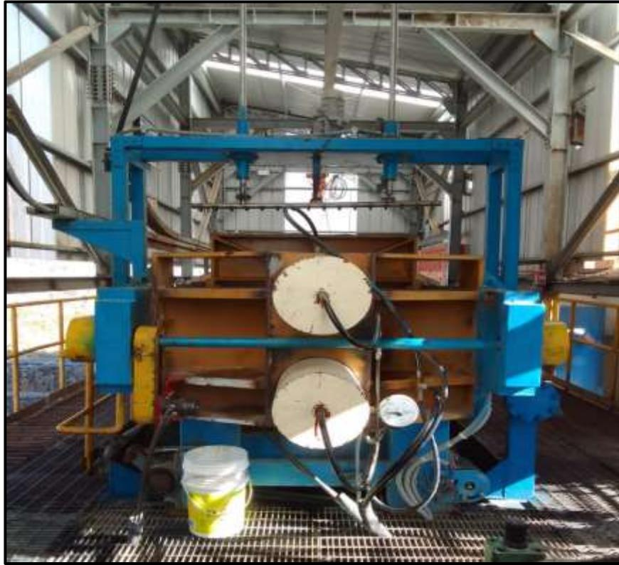
**Figura 18.** Estructura interna del filtro prensa de lodos para el cambio de lonas y placas.
