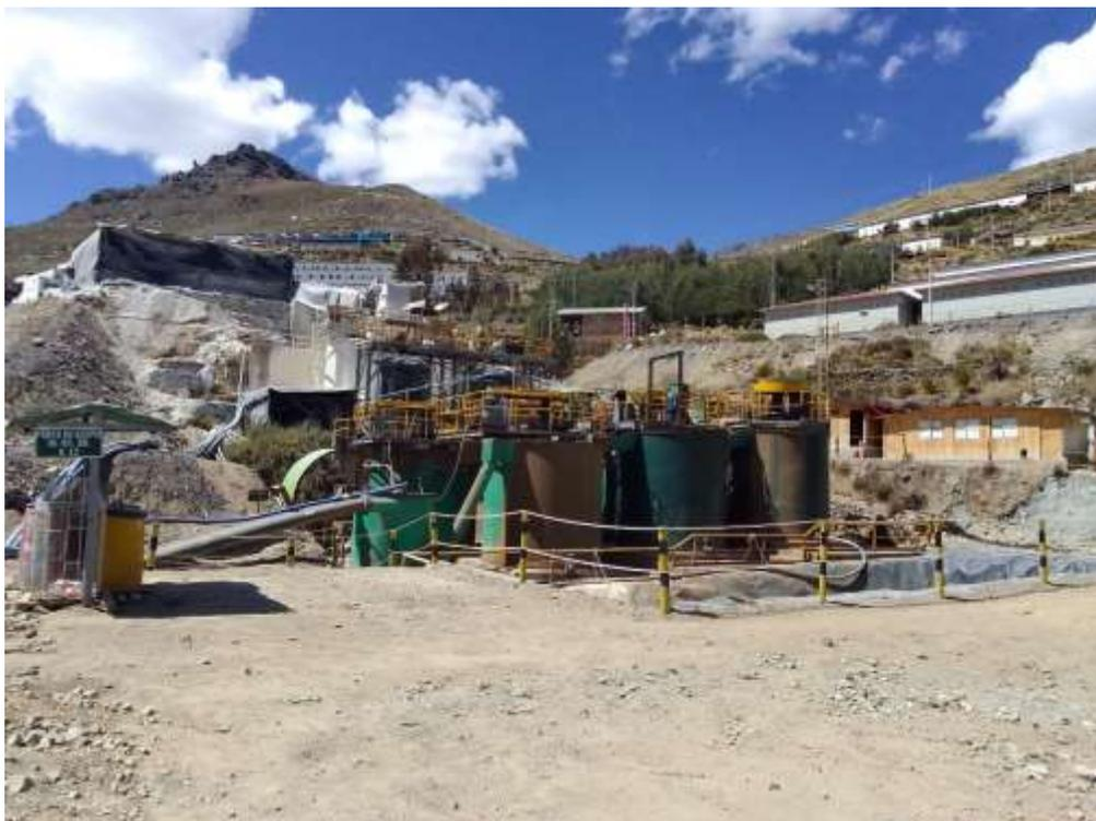
**ANEXO N° 14:** Ingreso de agua ácida hacia el presedimentador con una coloración rojiza con un pH de 3.5 y plomiza con un pH de 5.9.
