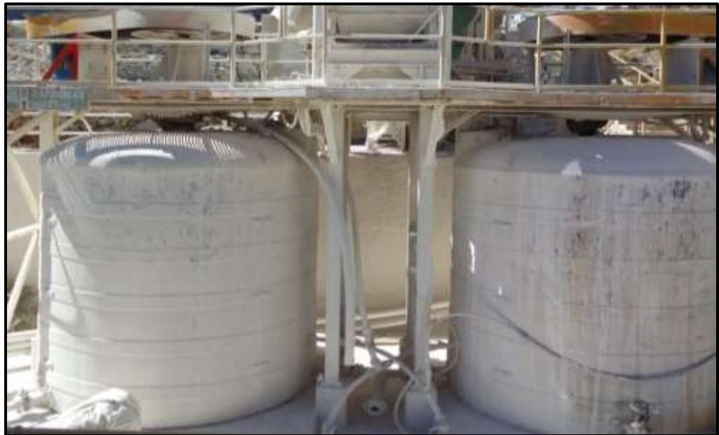
**Figura 12.** Tanques de preparación de lechada de cal N° 1 y N° 2
