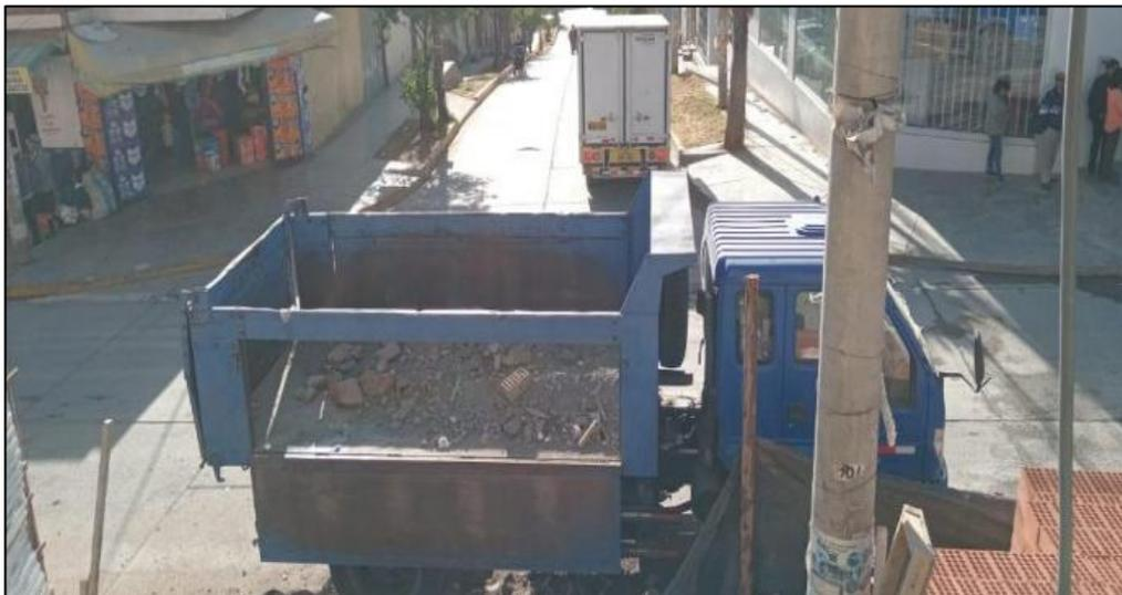
**Figura 7.** Volquete para transporte de material excedente
