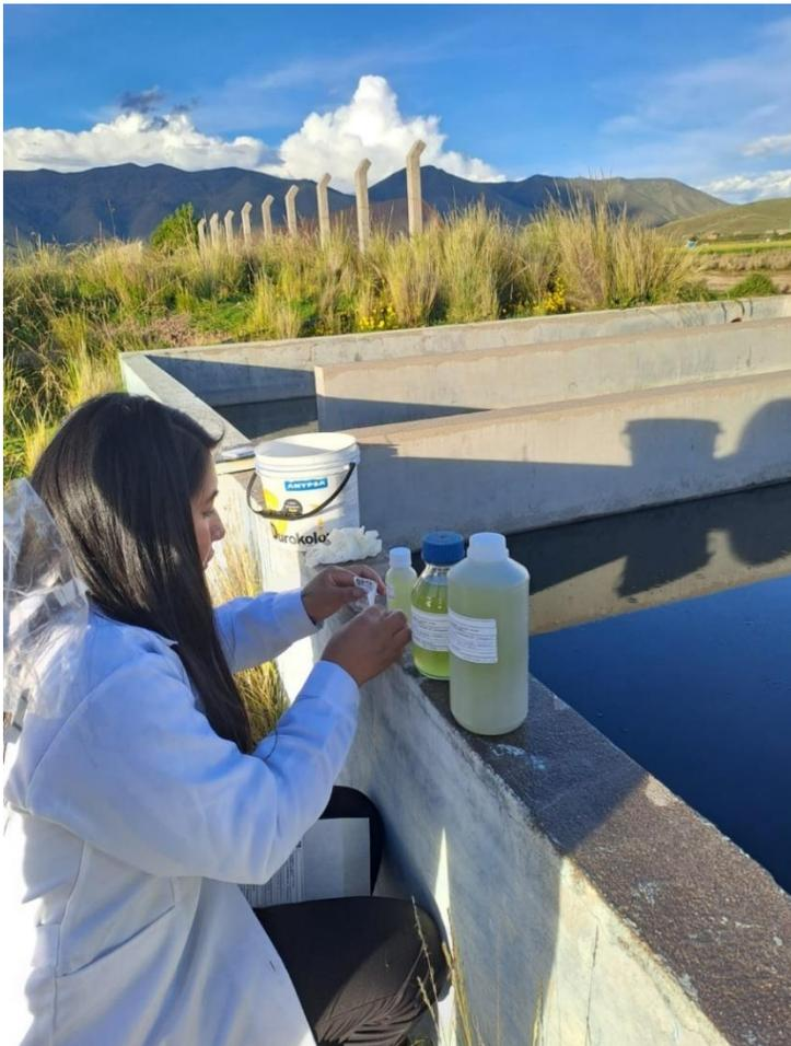
*Fotografía 14. Muestras de agua residual para el análisis en el laboratorio BHIOS*
