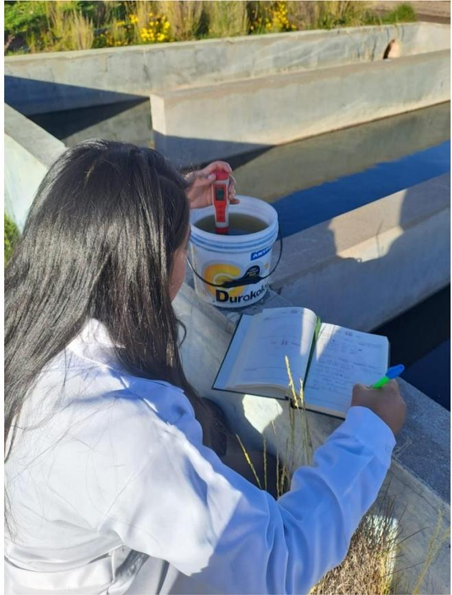
*Fotografía 13. Toma de muestras del vertimiento de agua residual*
