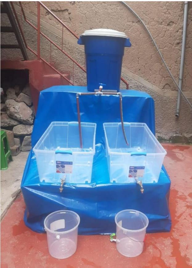
*Fotografía 6. Diseño de planta piloto de humedal artificial de flujo subsuperficial*
