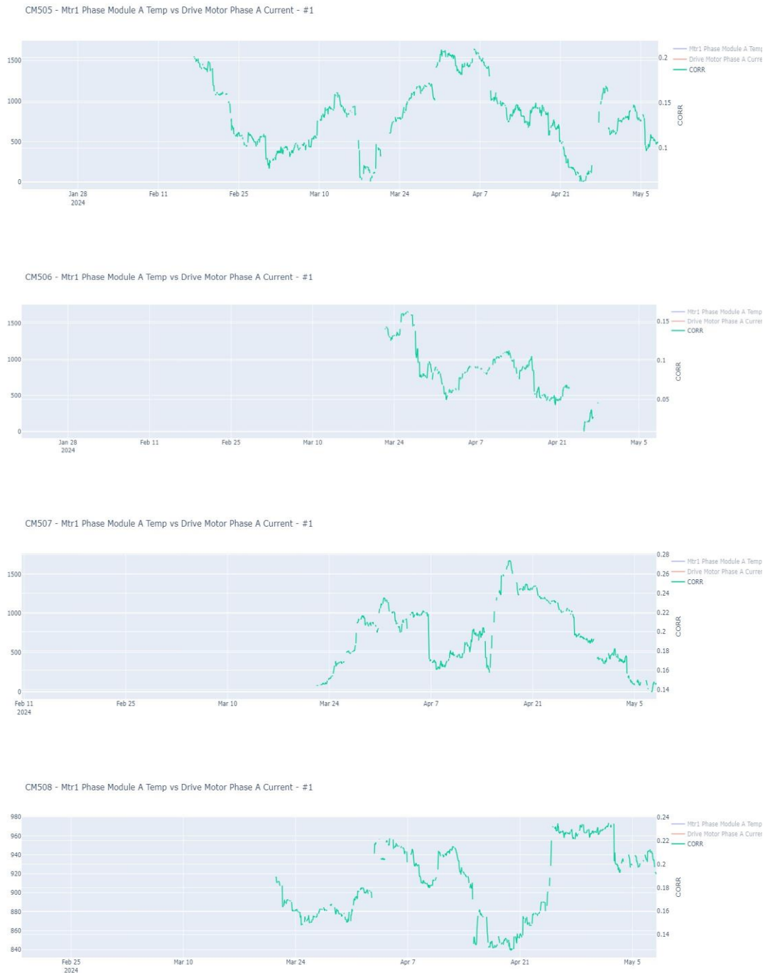
Figura 44. Correlación en el tiempo de la temperatura y corriente de los módulos de fase por camión.
