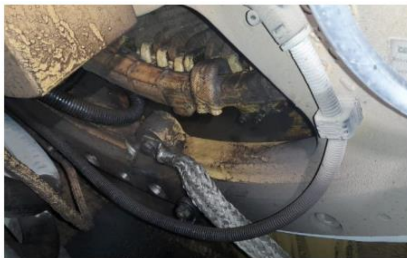
Figura 20. Presencia de contaminación por aceite en el motor de tracción.
