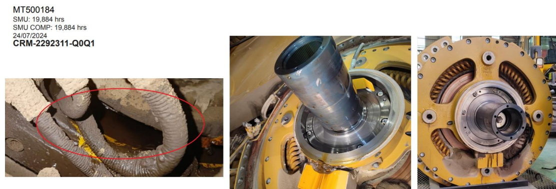
Figura 22. Evidencia de contaminación por aceite en el motor de tracción y sus componentes internos.
