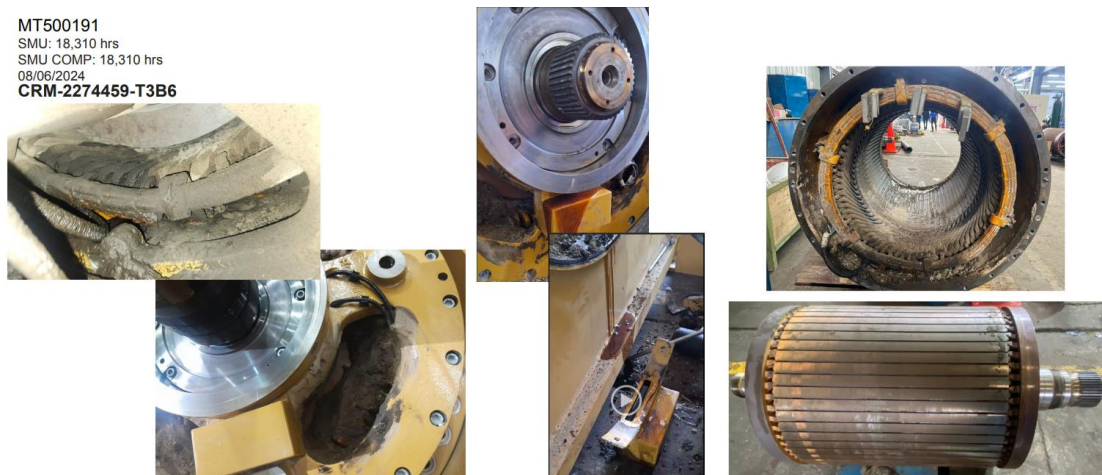
Figura 21. Inspección de componentes internos del motor de tracción tras operación prolongada.
