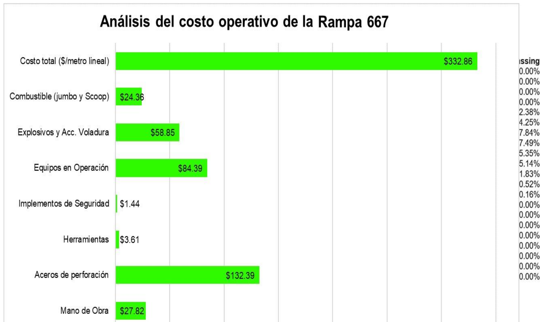
Figura 16. Análisis de los costos de perforación y voladura de la Rampa 667 Tomada de Estructura de costos de perforación y voladura de la Rampa 616, Unidad Minera San Cristóbal (14)
