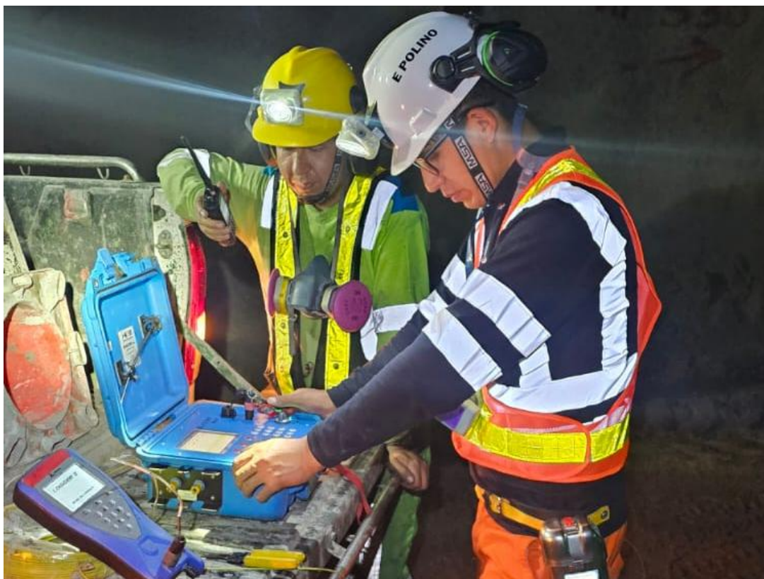
Fotografía 2. Detonación con el Blaster 3000 del Tj 821G-OB6A.
