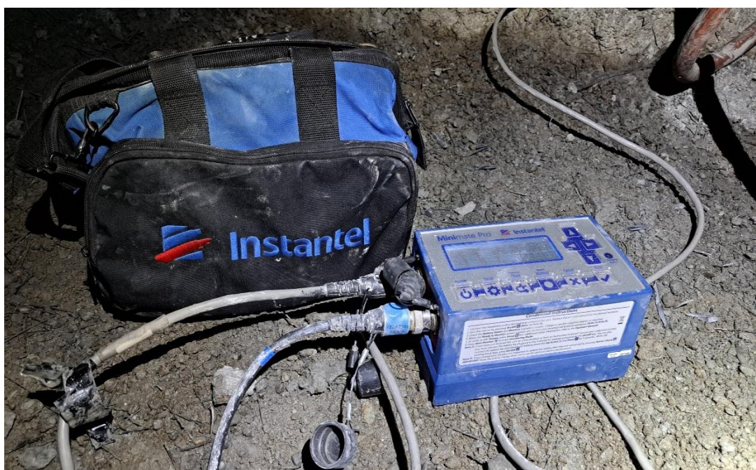
Fotografía 4. Toma de muestra de registro de vibraciones con sismógrafo Instantel – 2da parte.
