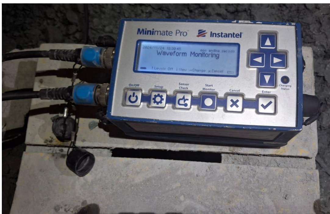
Fotografía 3. Toma de muestra de registro de vibraciones con sismógrafo Instantel – 1ra parte.
