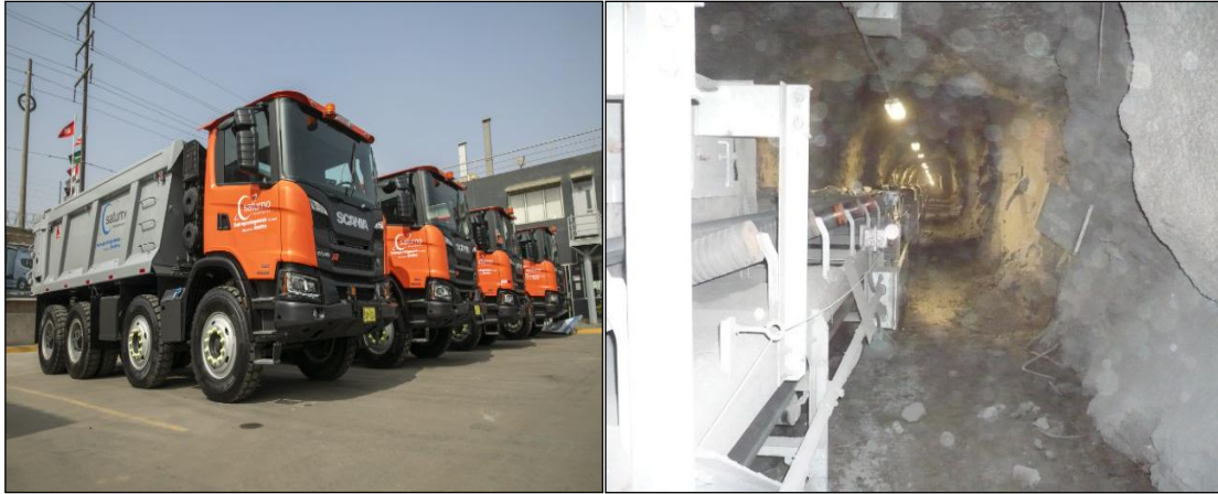
Figura 10. Volquete Scania G540 - B8X4 (izquierda) y faja transportadora N°3 salida de mina a superficie (derecha)
