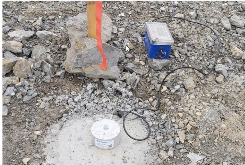
Figura 23. Instalación de sismógrafo y geófono en campo
