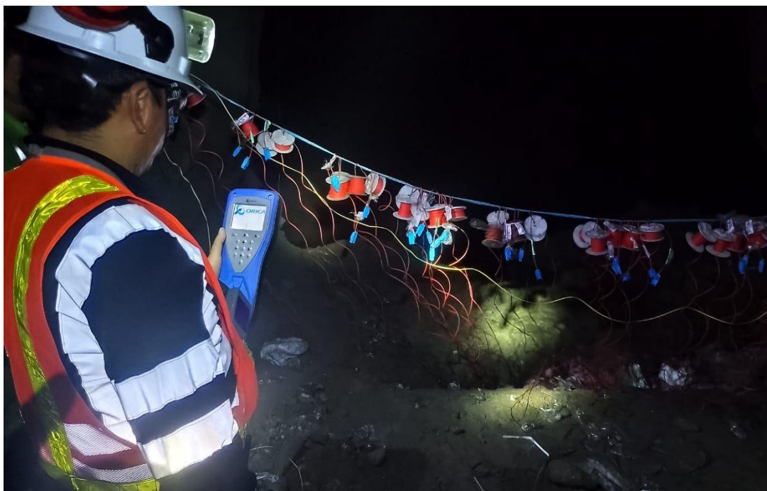
Fotografía 5. Proceso de testeo con el Logger II - Tj 821G-OB6A – 1ra parte.
