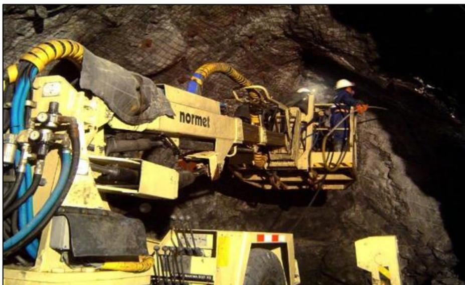
*Figura 6. Anfo Loader realizando el carguío en un frente en breasting*
