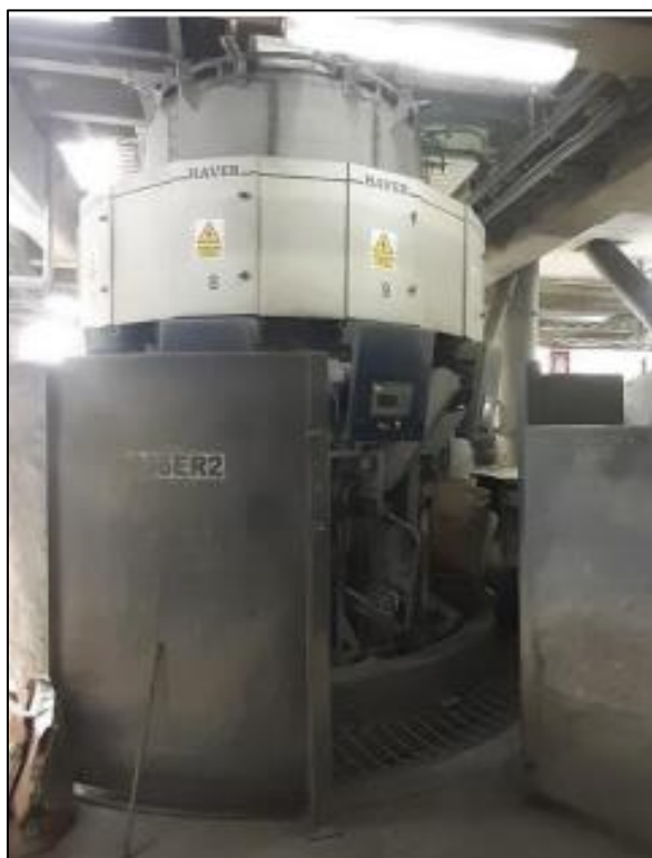
Figura 6. Ensamadora rotativa Fuente: Osorio (16)
