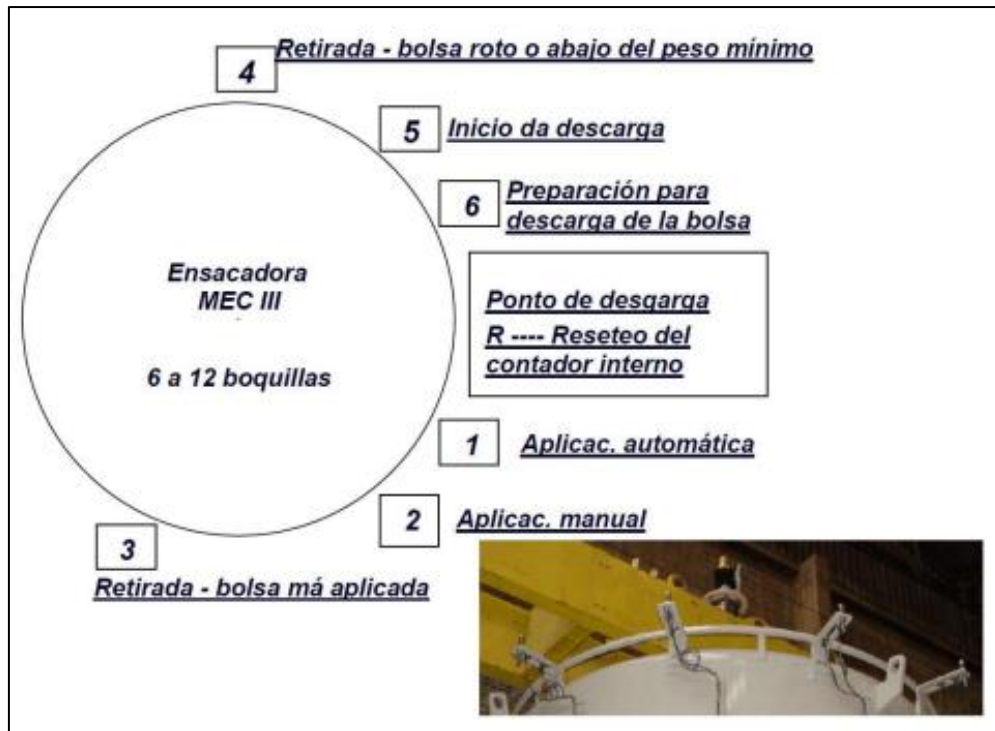
Figura 21. Ubicación se sensores inductivos
