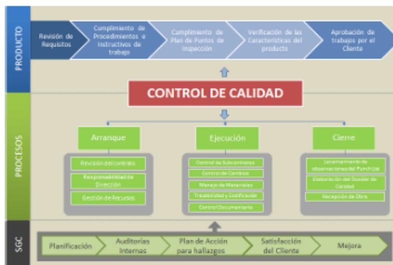
Figura 5: Diagrama del Control de la Calidad en el Proyecto
