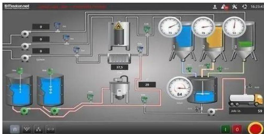
**Figura 15.** Sistema de supervisión, control y adquisición de datos con software *Movicon*
