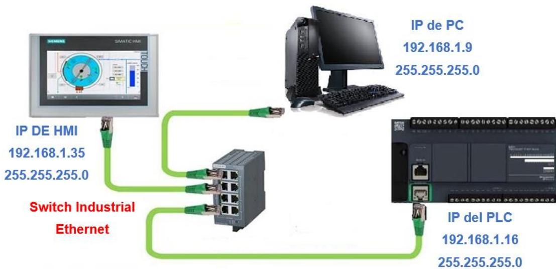
*Figura 62. Control de proceso de automatización de una miniplanta dosificadora y envasadora controlada por PLC, y supervisado por PC y HMI.*
