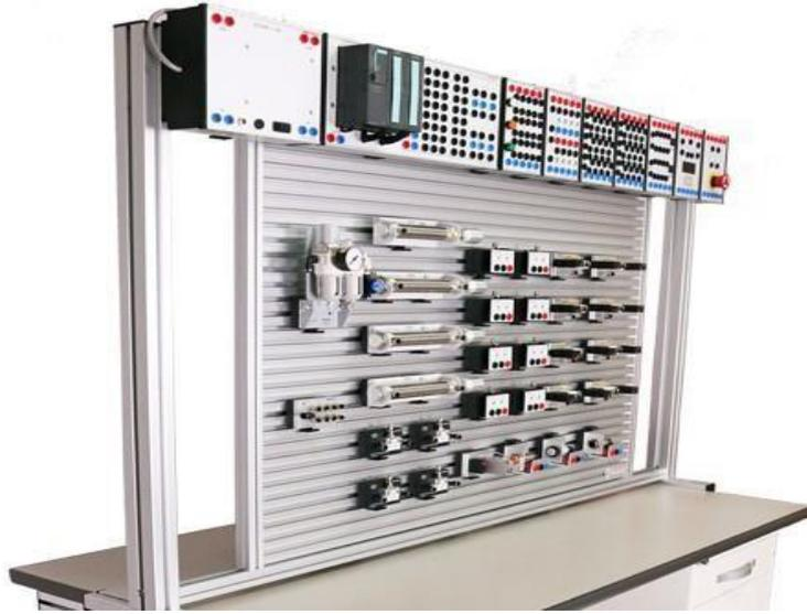
*Figura 16. Módulo didáctico de entrenamiento electroneumático automatizado por hardware y software*
