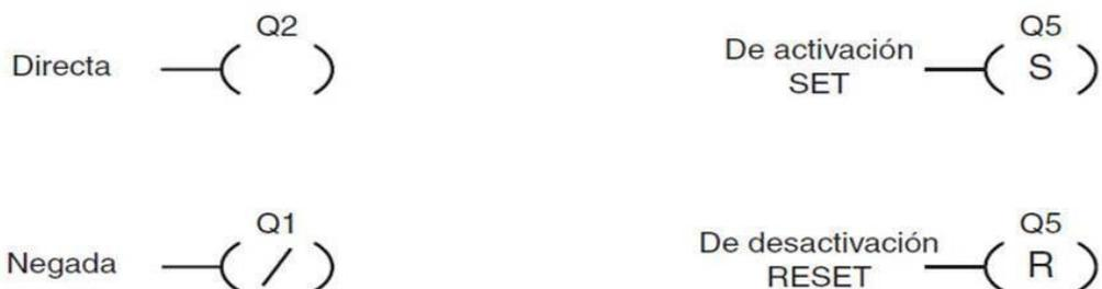
**Figura 7. Ejemplo de bobinas en lenguaje de programación Ladder**
