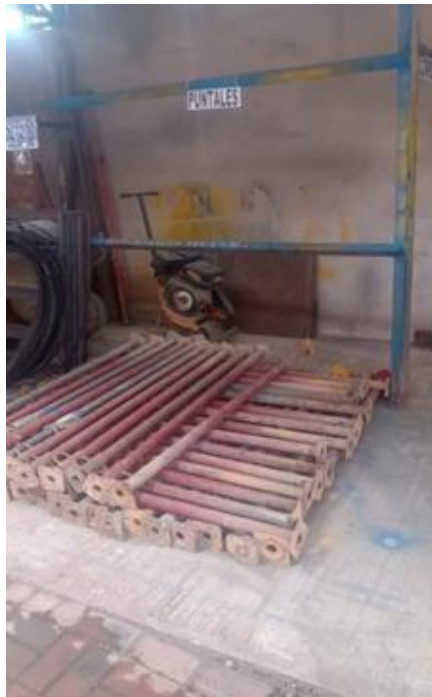
Figura 33 Almacén para puntales metálicos
