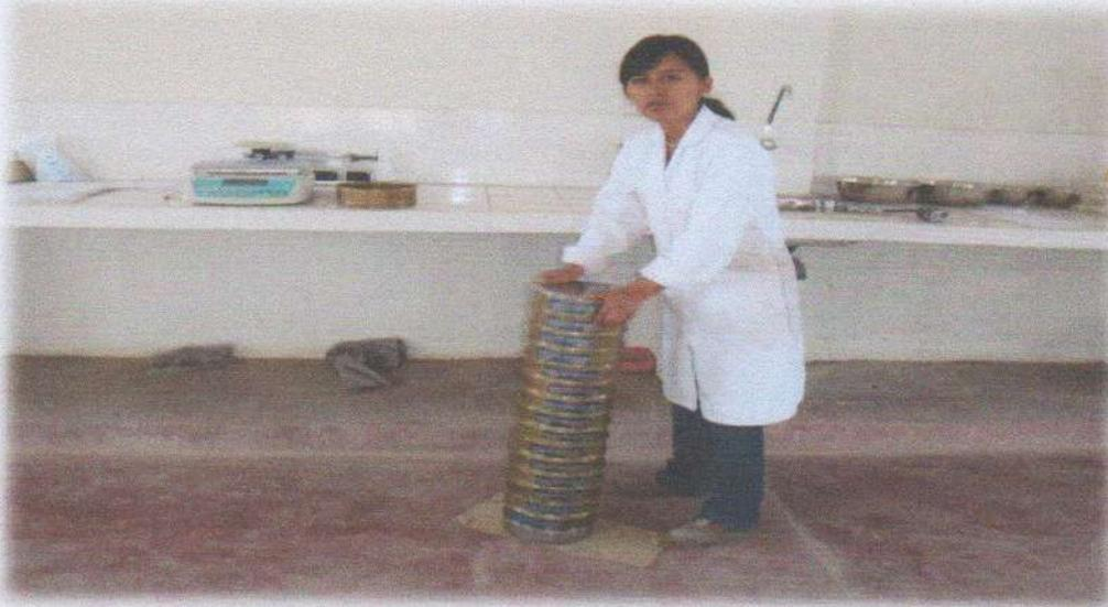
**Fotografía N° 1:** Vista panorámica de los ensayos en laboratorio de las calicatas. Después de tener la muestra uniforme obtenida por cuarteo, pesar la muestra seleccionada y llevarla al horno durante 24 horas o hasta obtener una masa constante. Una vez secada la muestra y enfriada, se procede a tomar el peso de la muestra secada al horno y tomar el peso del material requerido y lavarlo a través del tamiz N° 200
