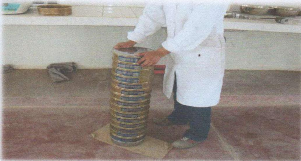
**Fotografía N° 2:** Vista panorámica de los ensayos en laboratorio de las calicatas. El análisis granulométrico de la fracción que pasa el tamiz (N° 4) se hará por TAMIZADO Y/O SEDIMENTACIÓN según las características de la muestra y según la información requerida. Esta parte de la porción se procede a analizar de la misma forma que la anterior para el material retenido en el tamiz N° 200.
