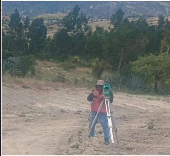
Descripción: levantamiento topográfico
