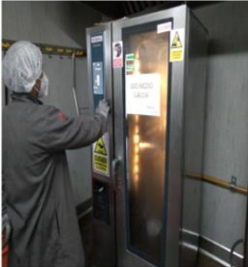
**Imagen 2** – equipo Rational con fallas en el sistema de precalentamiento
