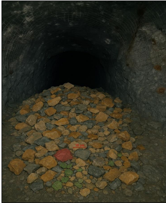
Figura 13. Análisis de la granulometría en galería, mediante software Wipfrag 3.3
