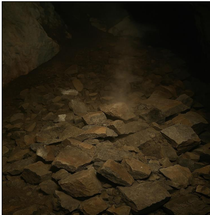
Figura 14. Posvoladura en chimenea RC 72, Unidad Marañón
