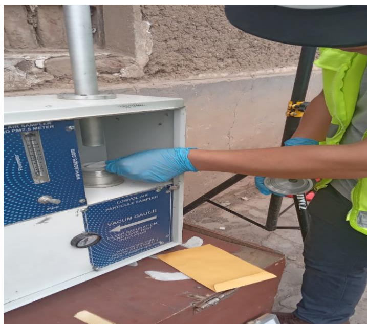
Figura 10. Instalación y manipulación del tren de muestreo
