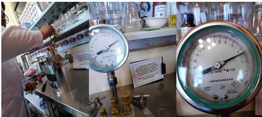
Figura 69 Ensayo de contenido de aire
