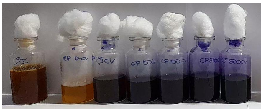
Figura 4. Desarrollo de experimento de biodegradación de colorante azo cristal violeta por levadura residual industrial (LRI) en medio de caldo de papa (CP). El primer vial (control) contiene solo LRI en vinaza de caña de azúcar, del 2.º al 7.º vial se observa la LRI en medio CP con 0, 25, 50, 100, 300 y 500 mg/L de CV
