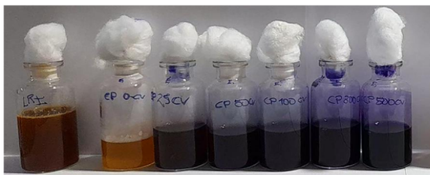
Figura 4. Desarrollo de experimento de biodegradación de colorante azo cristal violeta por levadura residual industrial (LRI) en medio de caldo de papa (CP). El primer vial (control) contiene solo LRI en vinaza de caña de azúcar, del 2.º al 7.º vial se observa la LRI en medio CP con 0, 25, 50, 100, 300 y 500 mg/L de CV
