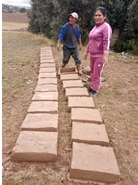
Foto 4. Mejoramiento de las propiedades físico mecánicas del adobe al incorporar viruta y caucho Acoria – Huancavelica
