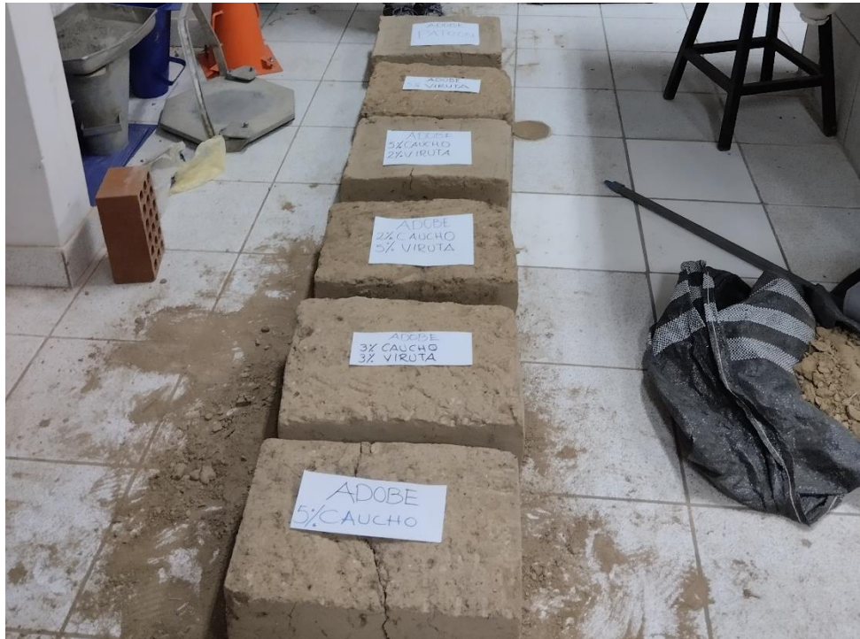
Foto 5. Variaciones de las propiedades físico mecánicas del adobe al incorporar viruta y caucho Acoria – Huancavelica
