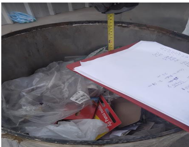
Fotografía 11: Sacando la altura libre del cilindro
