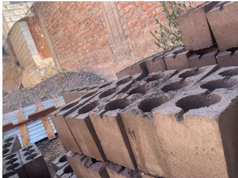
Fotografía N° 8: Curado de los bloques de concreto.
