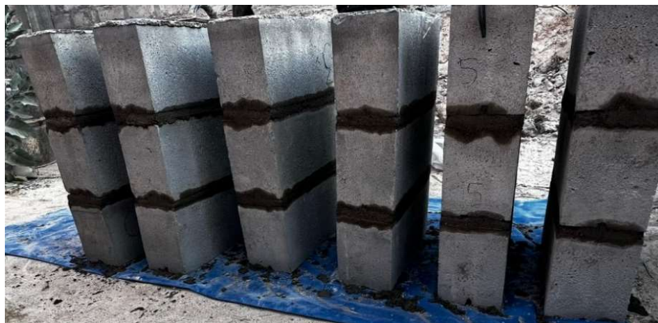
Fotografía N.º 10: Elaboración de pilas de bloques de concreto.
