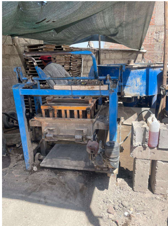
Fotografía N° 6: Elaboración de los bloques de concreto.
