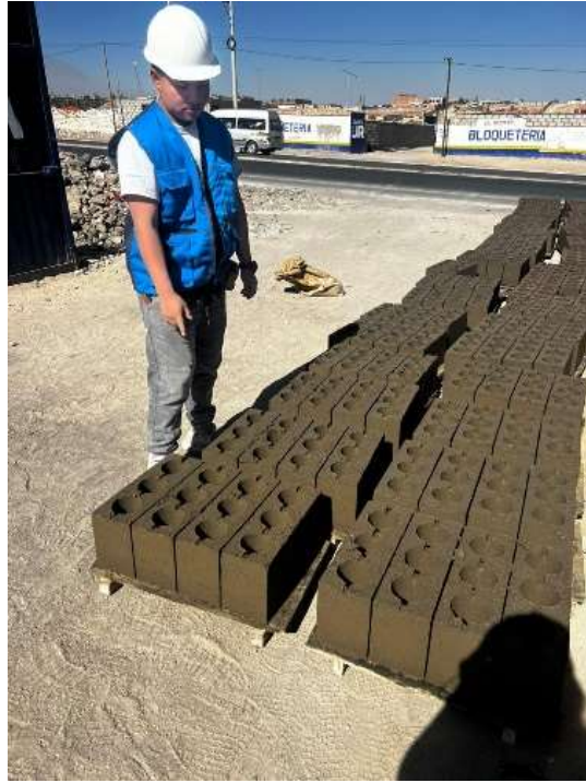
Fotografía N° 7: Curado de los bloques de concreto.
