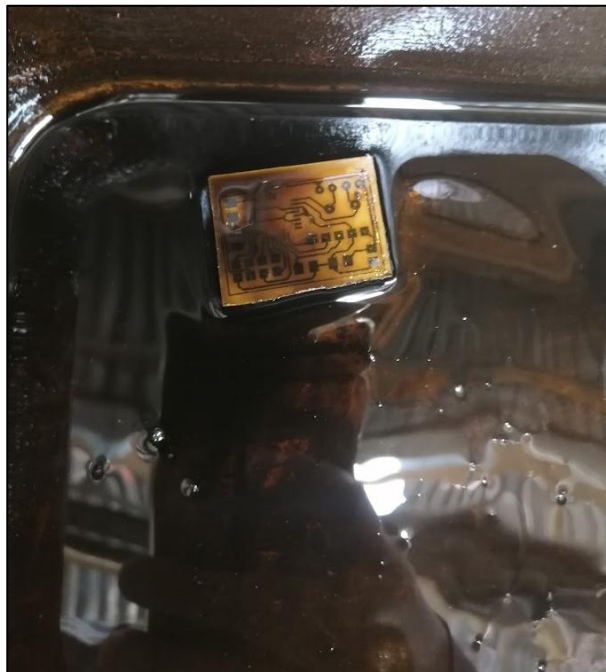
Figura 66. Proceso de grabado con ácido bórico.
