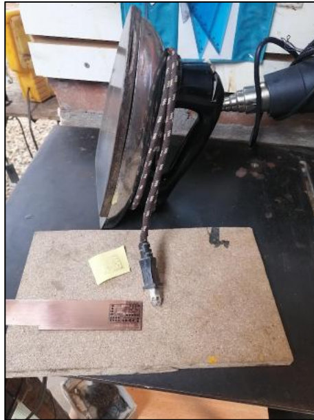
Figura 65. Transferencia de circuito impreso a la placa de PBC en baquelita.
