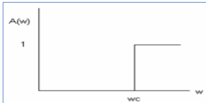
Figura 14: Respuesta ideal de un filtro ideal pasa alto. Tomada de Tesis Universidad Bio Bio (11)
