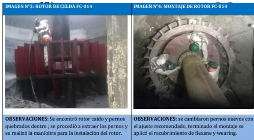
Figura 5. Montaje del rotor de la celda FC-014
