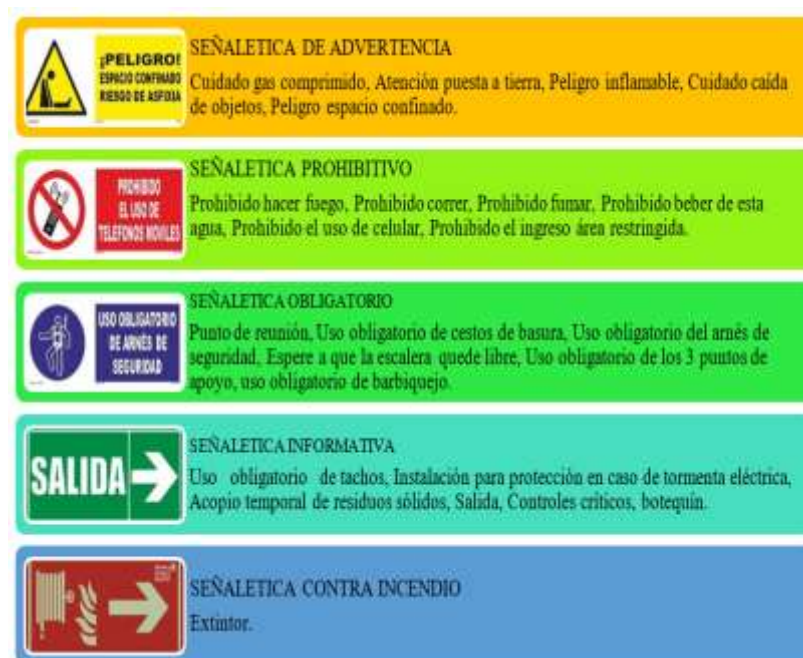
Figura 20. Señalización de acuerdo con el código de colores.
