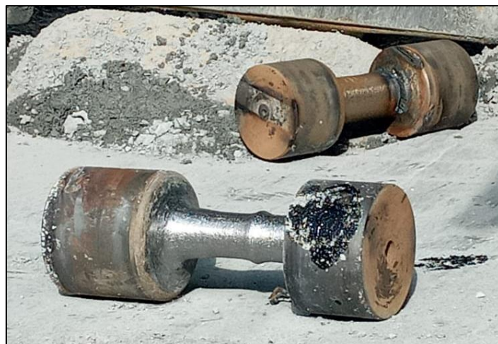
Figura 24 Desgaste de los pines de los Padlocks.
