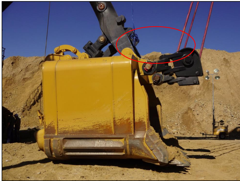
Figura 23 Bocina y pin son los componentes de una pala CAT 7495HR.
