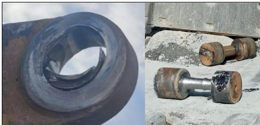
Figura 20.Desgaste al límite de bocinas y pines.
