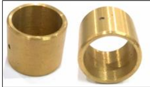
Figura 21. Bocina maquinada para el punto de lubricación
