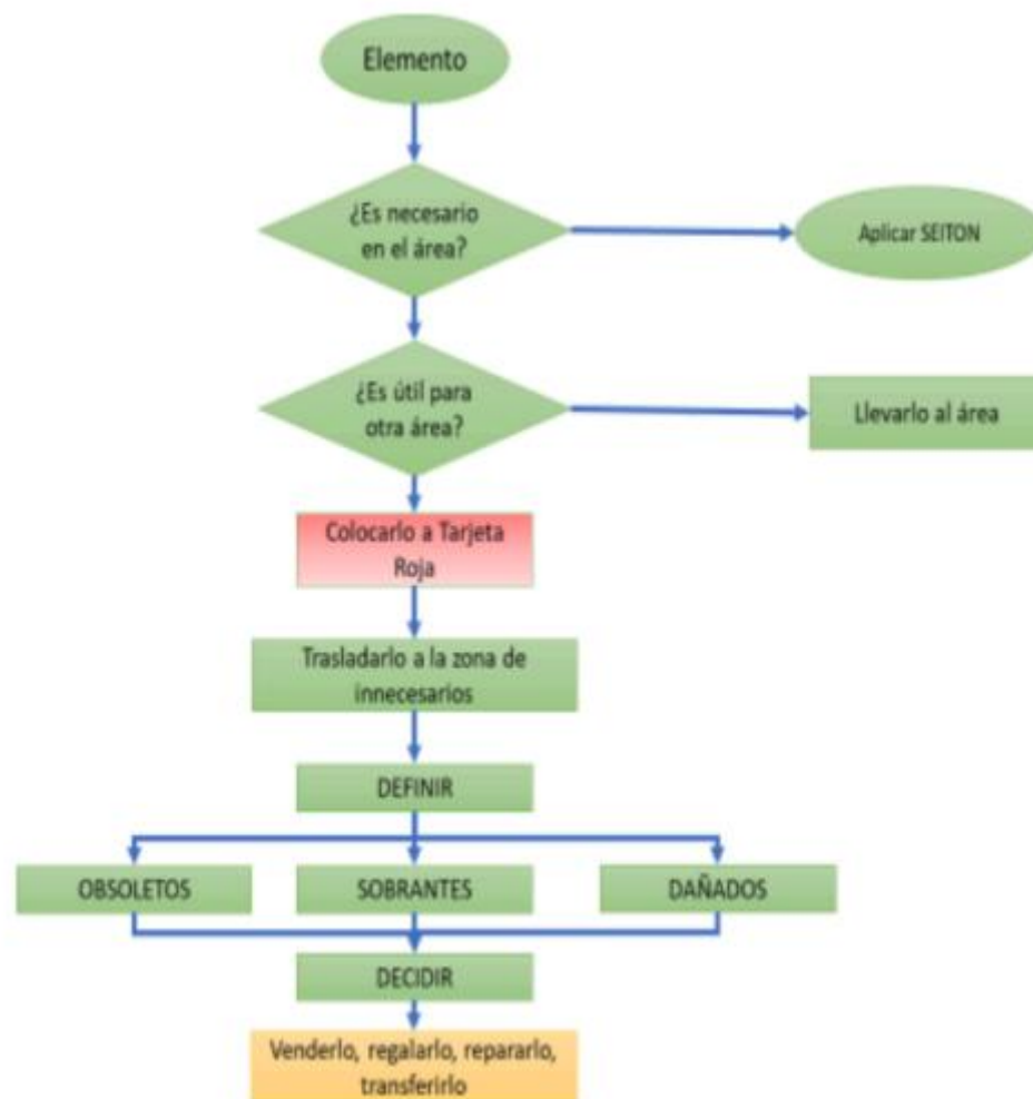
Figura 61. Flujo para clasificación de elementos en el almacén minero, basado en la propuesta de Carrasco para mejorar el entorno en la planta de procesamiento de Fitzcarrald.
