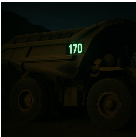
Figura 4. Simulación de la identificación con pintura fotoluminiscente.
