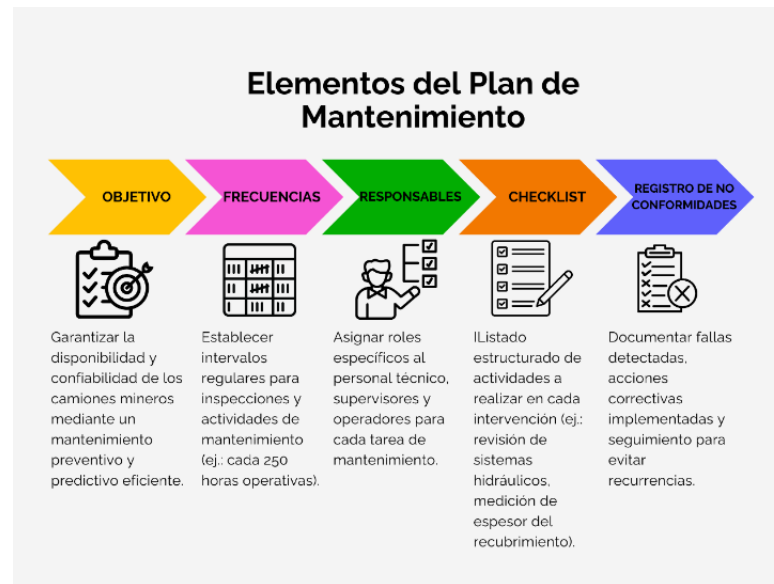
Figura 6. Estructura del plan de mantenimiento. Adaptado de ISO 55001 y prácticas recomendadas por Tecnología Minera (2025).
