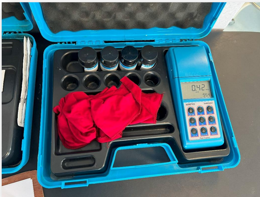
Figura 26. Turbidímetro Hanna HI98703
