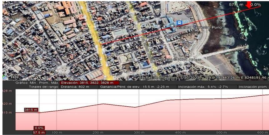
**Figura 41.** Perfil 01 con Cota del Nivel del Lago en 3815 msnm.
