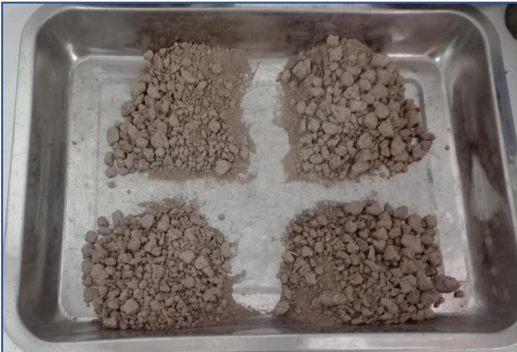
**Figura 80.** El cuarteo de las muestras es importante para tener una muestra representativa.
