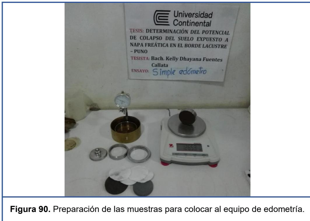
**Figura 90.** Preparación de las muestras para colocar al equipo de edometría.
