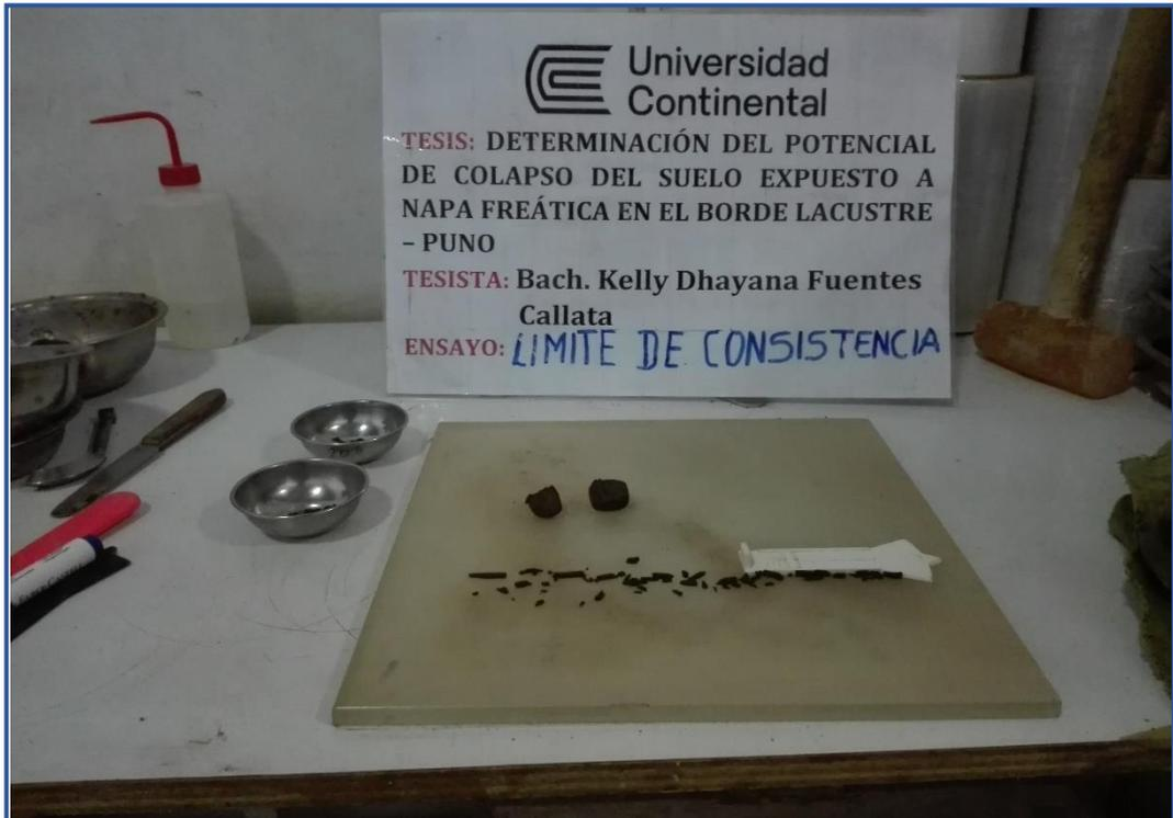
**Figura 85.** Ensayo de límite de plasticidad.
