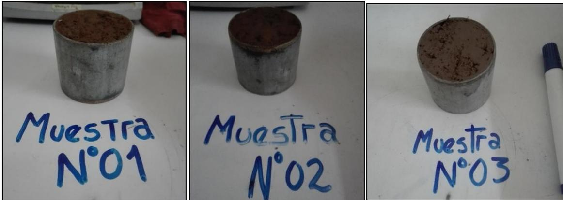
**Figura 26.** Muestras inalteradas para determinar su densidad.
