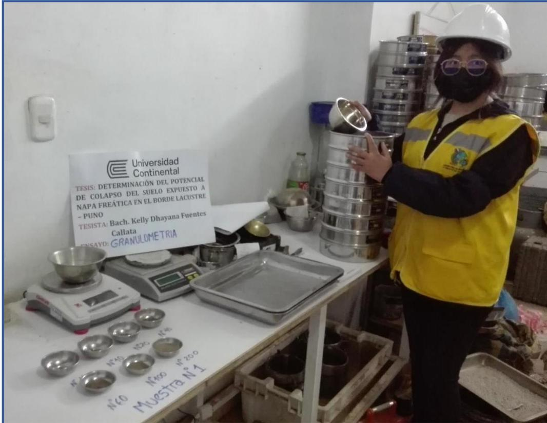
**Figura 87.** Tamizado de muestras – ensayo de granulometría.
