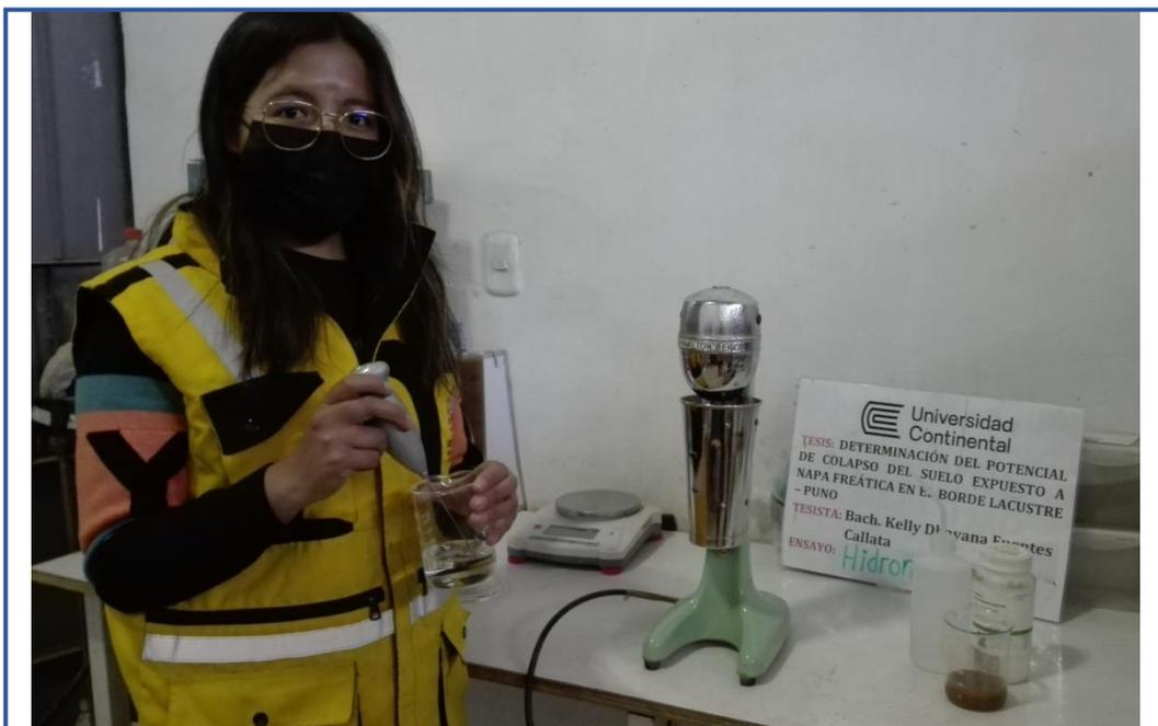
**Figura 95.** Ensayo de hidrometría, uso de batidora para mezclar el agua, la muestra y el hexametáfosfato.
