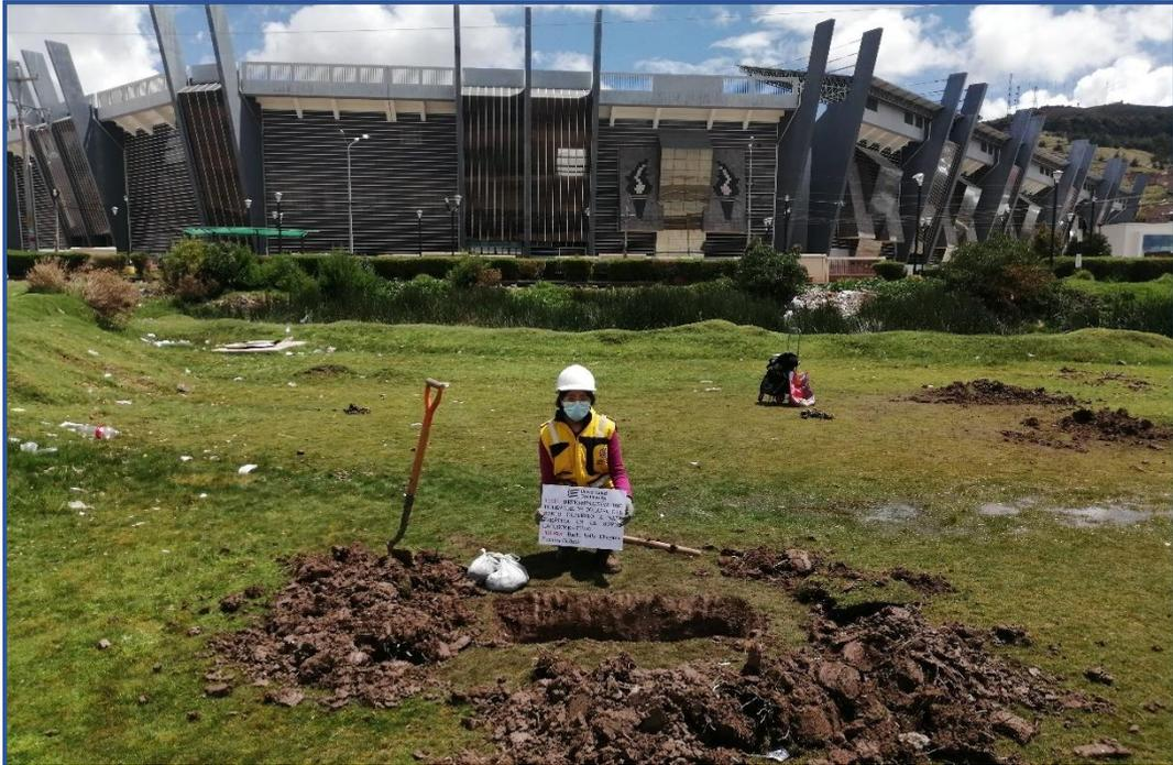
**Figura 79.** Exploración y muestreo de la calicata 03 – Universidad del altiplano.
