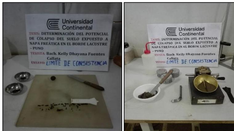
**Figura 23.** Se realizaron ensayos de muestras de suelo utilizando el método de Casagrande y la placa de vidrio esmerilado.
