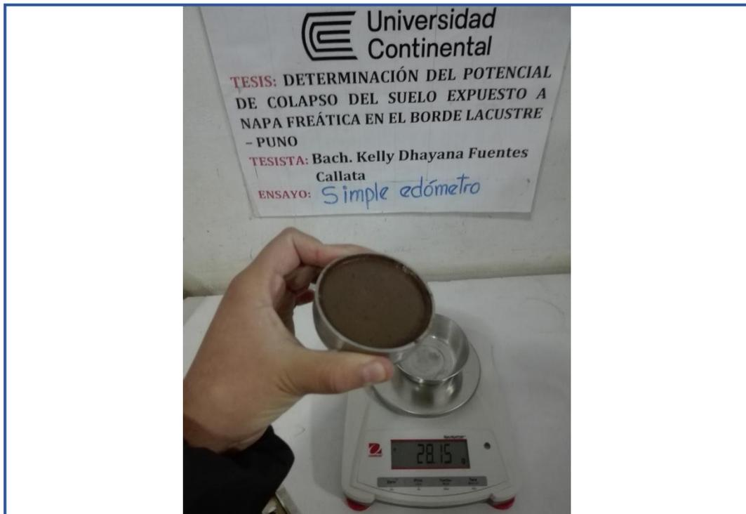
**Figura 94.** Muestras después del ensayo de colapso, se observa la deformación que sufrió la muestra.
