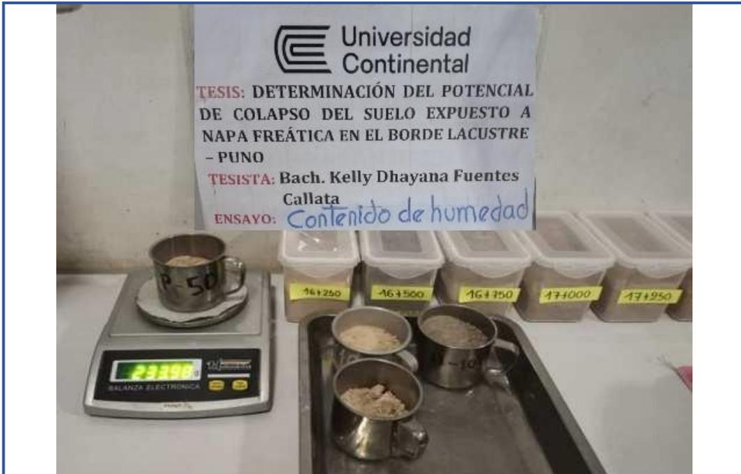
**Figura 81.** Muestras para determinar su contenido de humedad.
