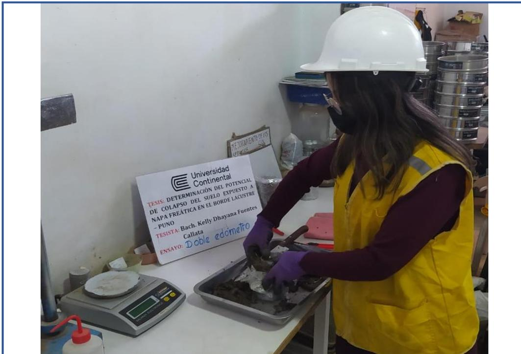
**Figura 89.** Moldeo de las muestras para los ensayos de simple y doble edómetro.
