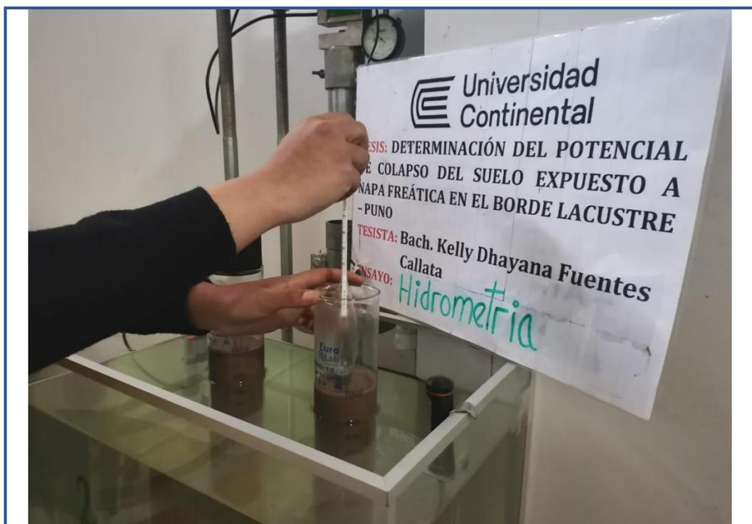
**Figura 96.** Medición de cimentación con el hidrómetro 152-H.
