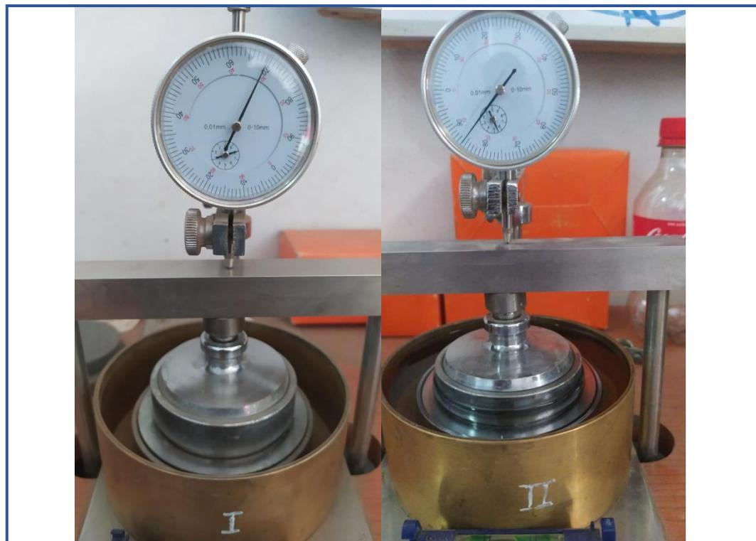
**Figura 92.** Ensayo de doble edómetro, sometemos a las muestras las mismas cargas, pero una con su humedad natural y la otra se inunda.
