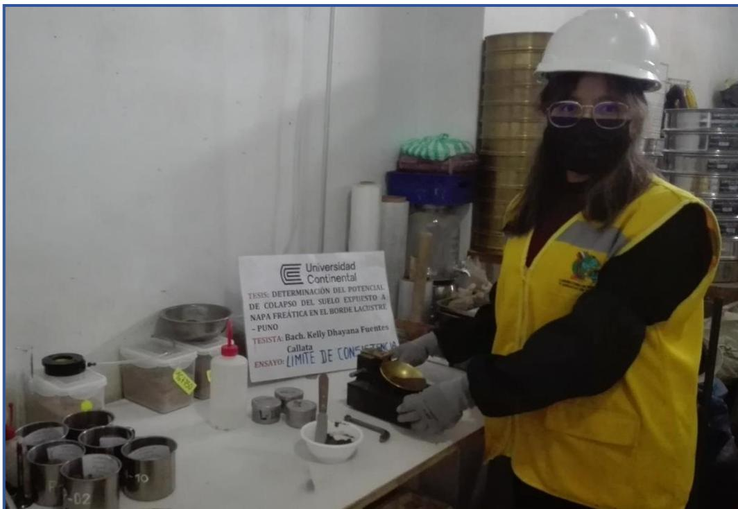
**Figura 84.** Ensayo de límite líquido en la cuchara de Casagrande.
