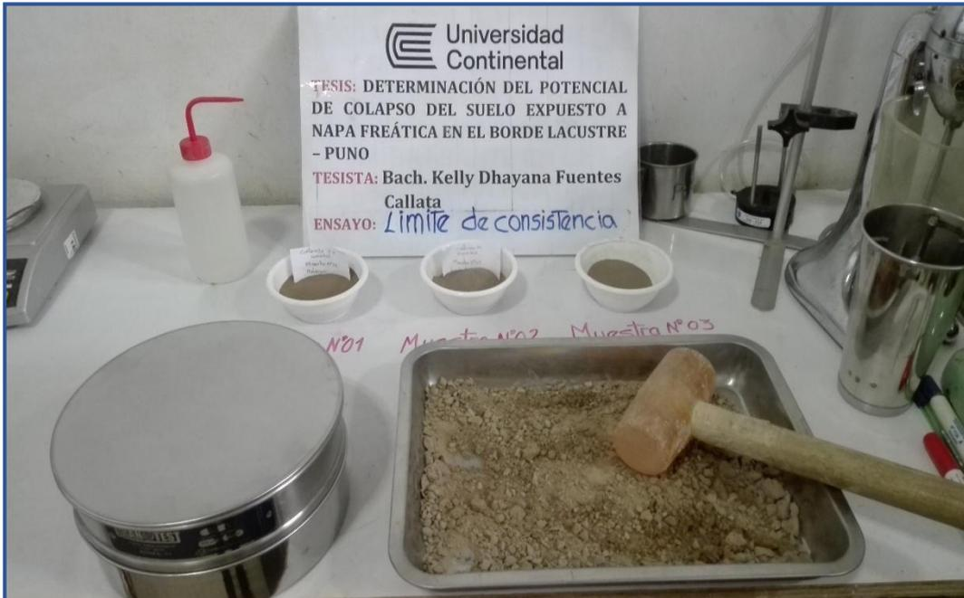
**Figura 83.** Preparación de las muestras para el ensayo de límites de consistencia.
