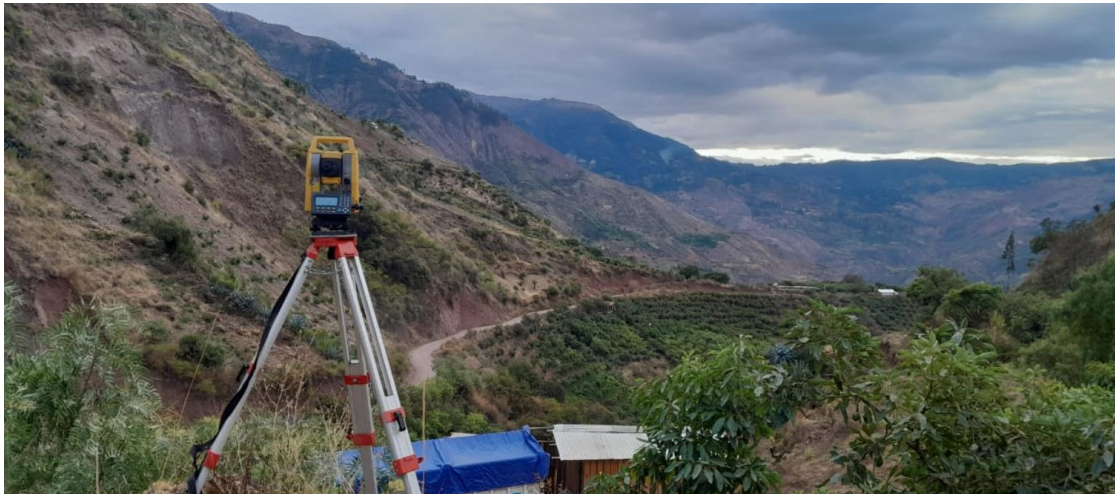
Vista del lugar donde se realizó el trabajo topográfico, marcando el BM_1, BM_2, E1 y E2 con la estación total marca Topcon para el inicio del trabajo
