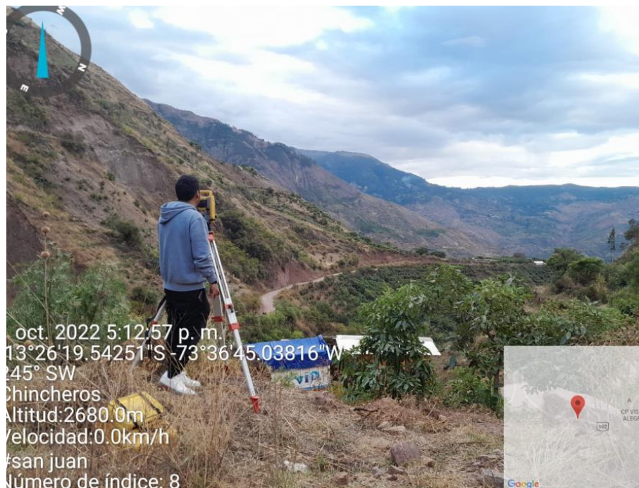
Revisión de la estación total antes del inicio del levantamiento topográfico.
