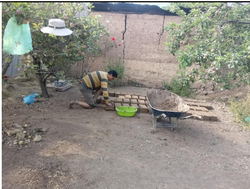
Foto N° 12. Proceso de elaboración de adobes. En la foto: Elaboración de adobes del Tratamiento N. ° 3 (Adición de 2% de ceniza de residuo de tarwi)
