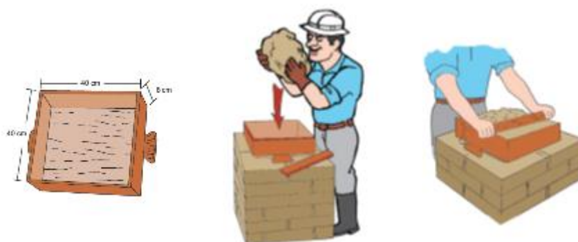
Figura 8. Elaboración del adobe Fuente. Edificación antisísmica de adobe (Manual de construcción)
