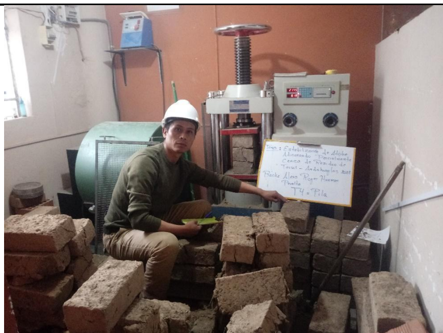
Foto N° 24. Ensayo de compresión axial por pila. Toma: Pila del Tratamiento N.º 4
