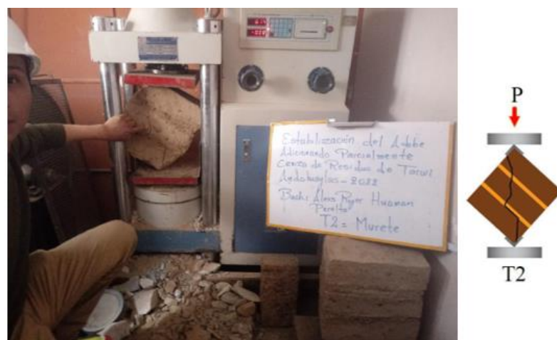
Figura 46. Murete del Tratamiento
