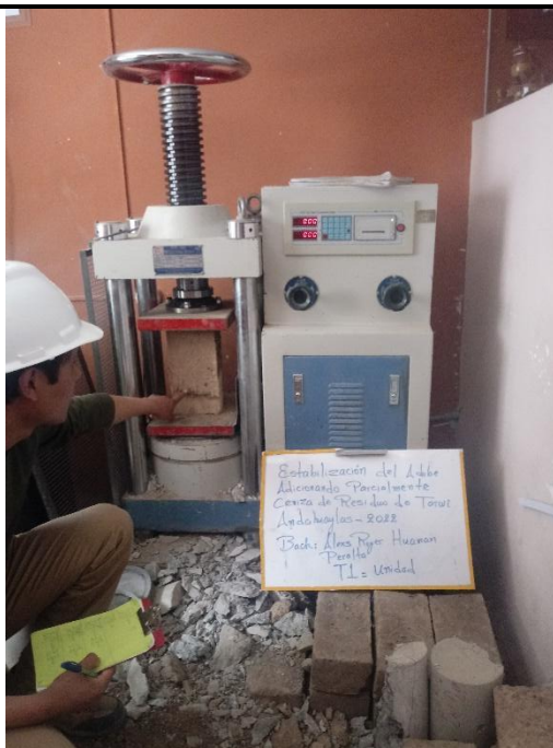
Foto N° 17. Ensayo de compresión axial por unidad. Toma: Espécimen del Tratamiento N.º 1
