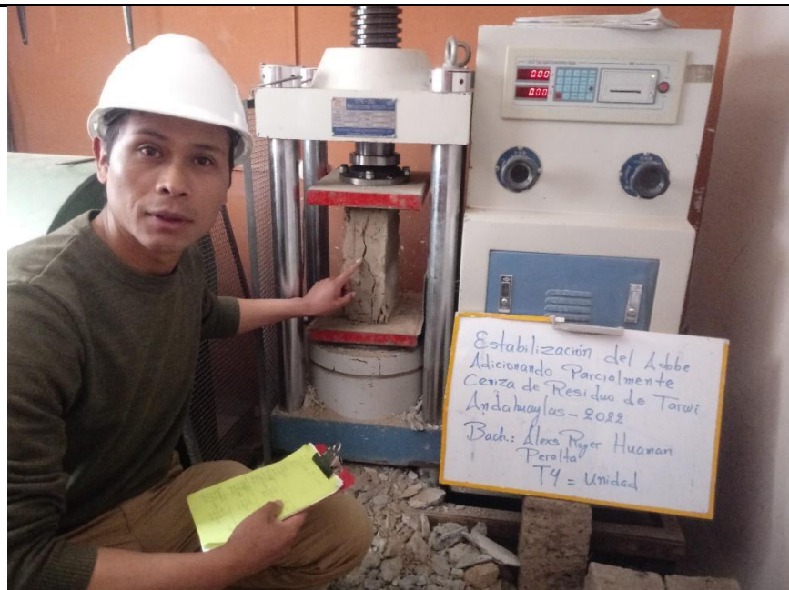
Foto N° 20. Ensayo de compresión axial por unidad. Toma: Espécimen del Tratamiento N. ° 4
