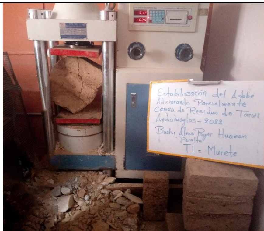
Foto N° 25. Ensayo de compresión diagonal en murete. Toma: Murete del Tratamiento N. ° 1
