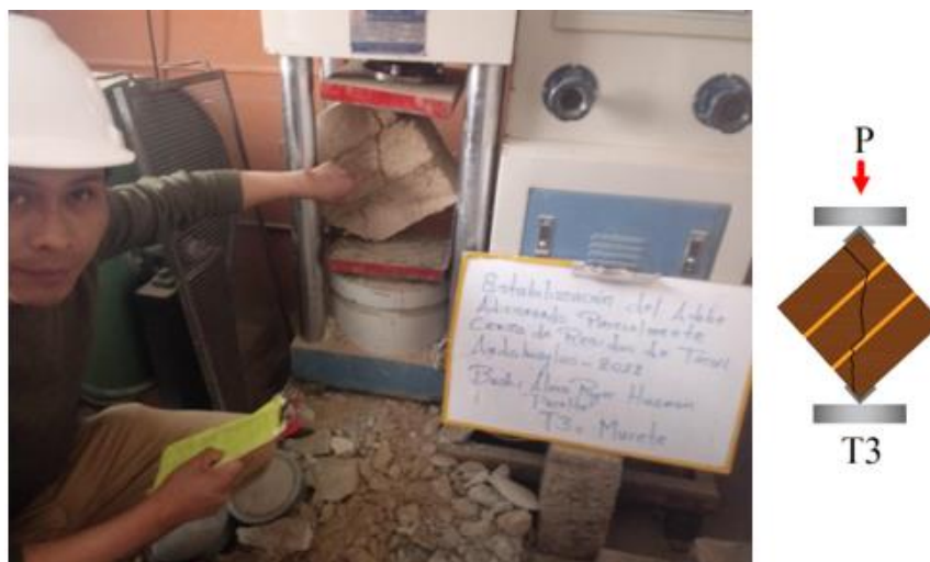
Figura 48. Murete del Tratamiento 3
