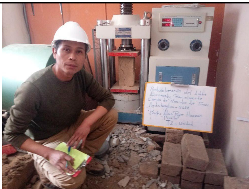
Foto N° 18. Ensayo de compresión axial por unidad. Toma: Espécimen del Tratamiento N.º 2
