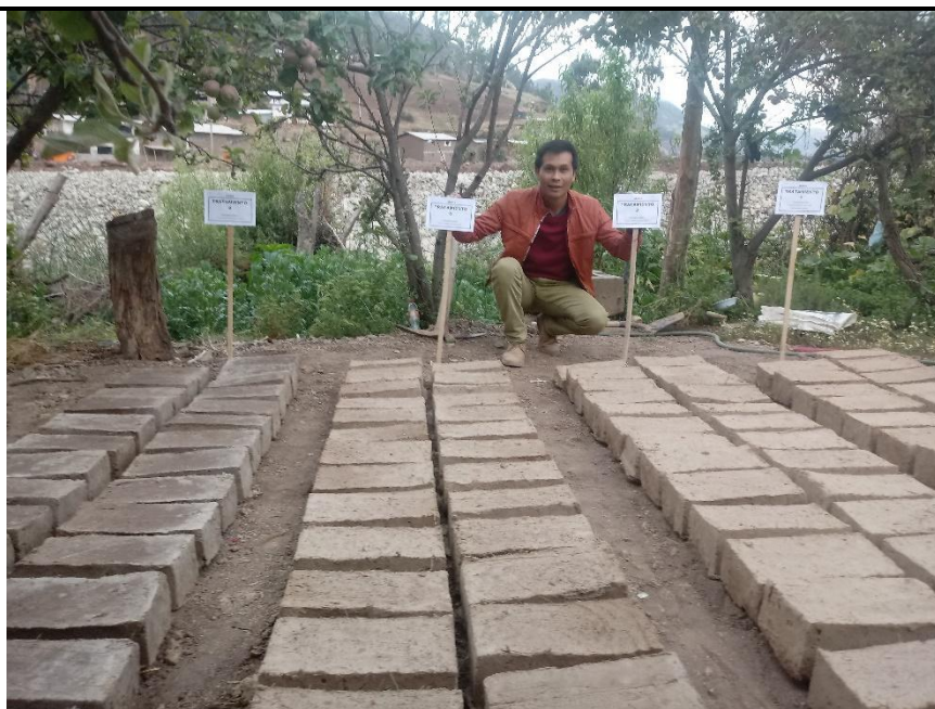
Foto N° 14. Adobes de los Tratamientos N. ° 1, 2, 3 y 4 con 14 días de edad en proceso de secamiento
