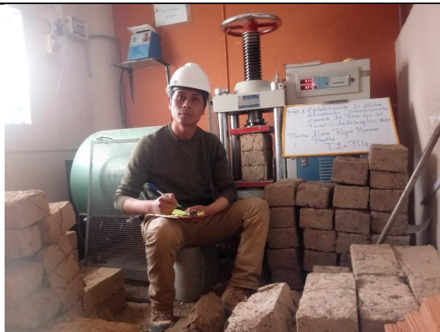
Foto N° 22. Ensayo de compresión axial por pila. Toma: Pila del Tratamiento N. ° 2
