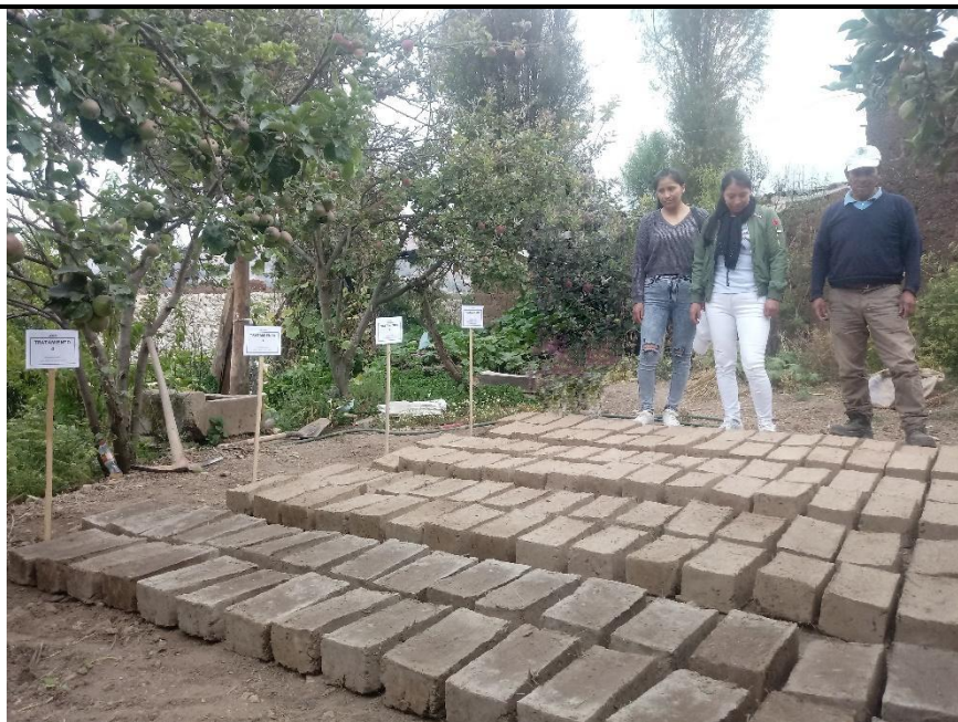
Foto N° 15. Adobes de los Tratamientos N.º 1, 2, 3 y 4 con 21 días de edad en proceso de secamiento
