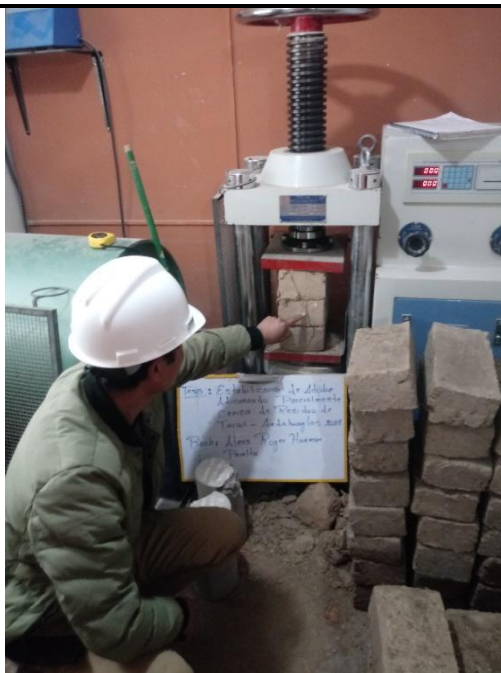
Foto N° 21. Ensayo de compresión axial por pila. Toma: Pila del Tratamiento N. ° 1
