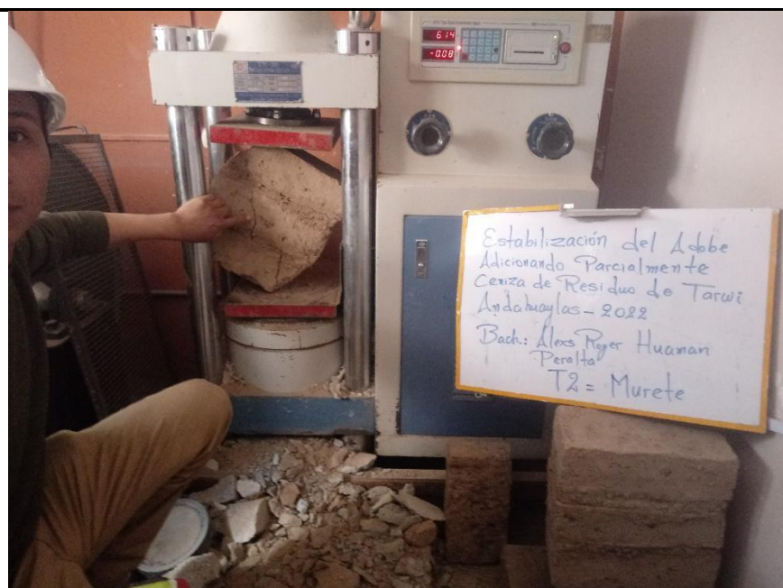
Foto N° 26. Ensayo de compresión diagonal en murete. Toma: Murete del Tratamiento N. ° 2
