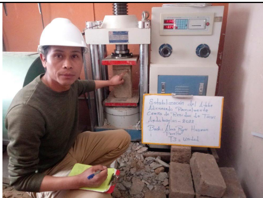
Foto N° 19. Ensayo de compresión axial por unidad. Toma: Espécimen del Tratamiento N. ° 3
