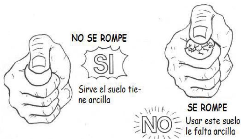
Figura 3. Prueba resistencia seca (prueba de la bolita de barro) Fuente. RNE 2017 (Norma E.080)
