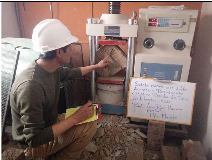
Foto N° 28. Ensayo de compresión diagonal en murete. Toma: Murete del Tratamiento N. ° 4
