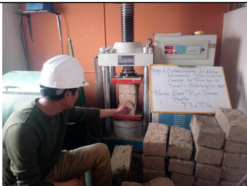
Foto N° 23. Ensayo de compresión axial por pila. Toma: Pila del Tratamiento N.º 3
