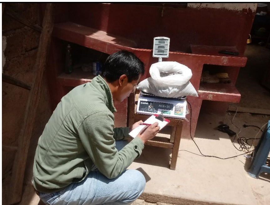
Foto N° 07. Pesado de ceniza de residuo de tarwi para los distintos tratamientos. Foto: Pesado para el Tratamiento N.º 2
