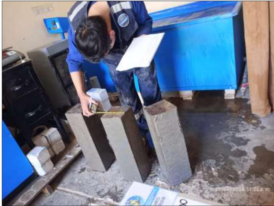
**Ensayo de ruptura de vigas de flexión.**
