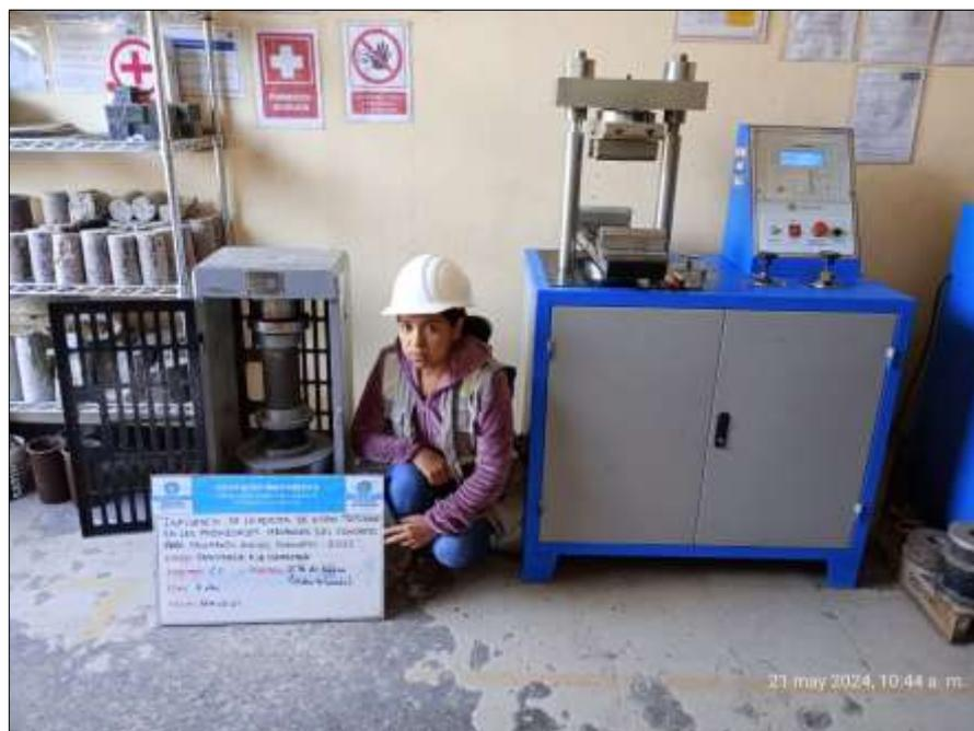
**Probetas cilíndricas con vidrio triturado al 2%.**
