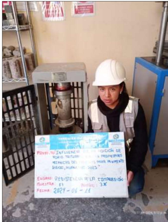
**Ensayo de resistencia a la compresión de cilindros de prueba, incorporación de vidrio al 3%.**
