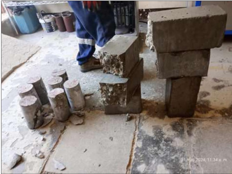
**Evaluación de punto de quiebre de las probetas de concreto ensayadas.**
