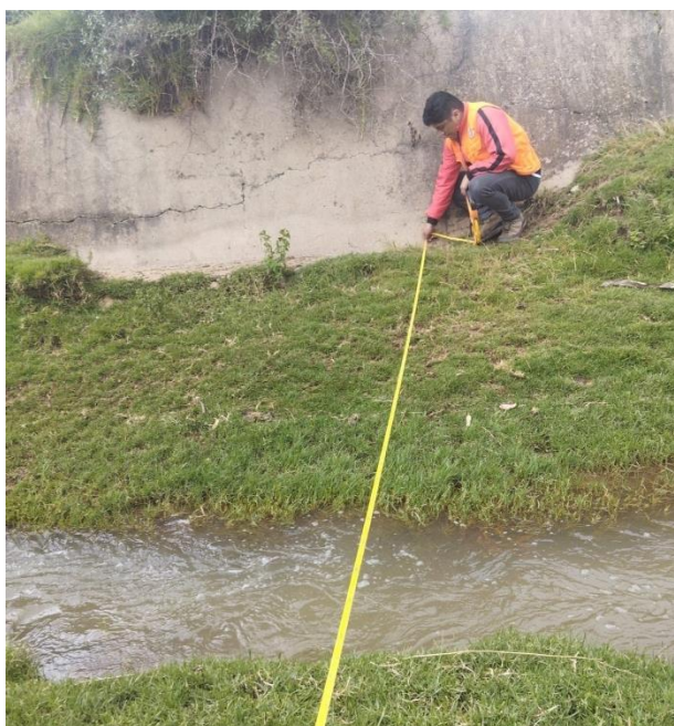
FOTOGRAFÍA N°01: Verificación del proyecto de pre -inversión: “Creación Del Servicio De Provisión De Agua Para Riego En La Comunidad De Quishuarcancha, Distrito De Tunan Marca, De La Provincia De Jauja, Del Departamento De Junín”, se realiza la verificación del ancho planteado por el consultor.
