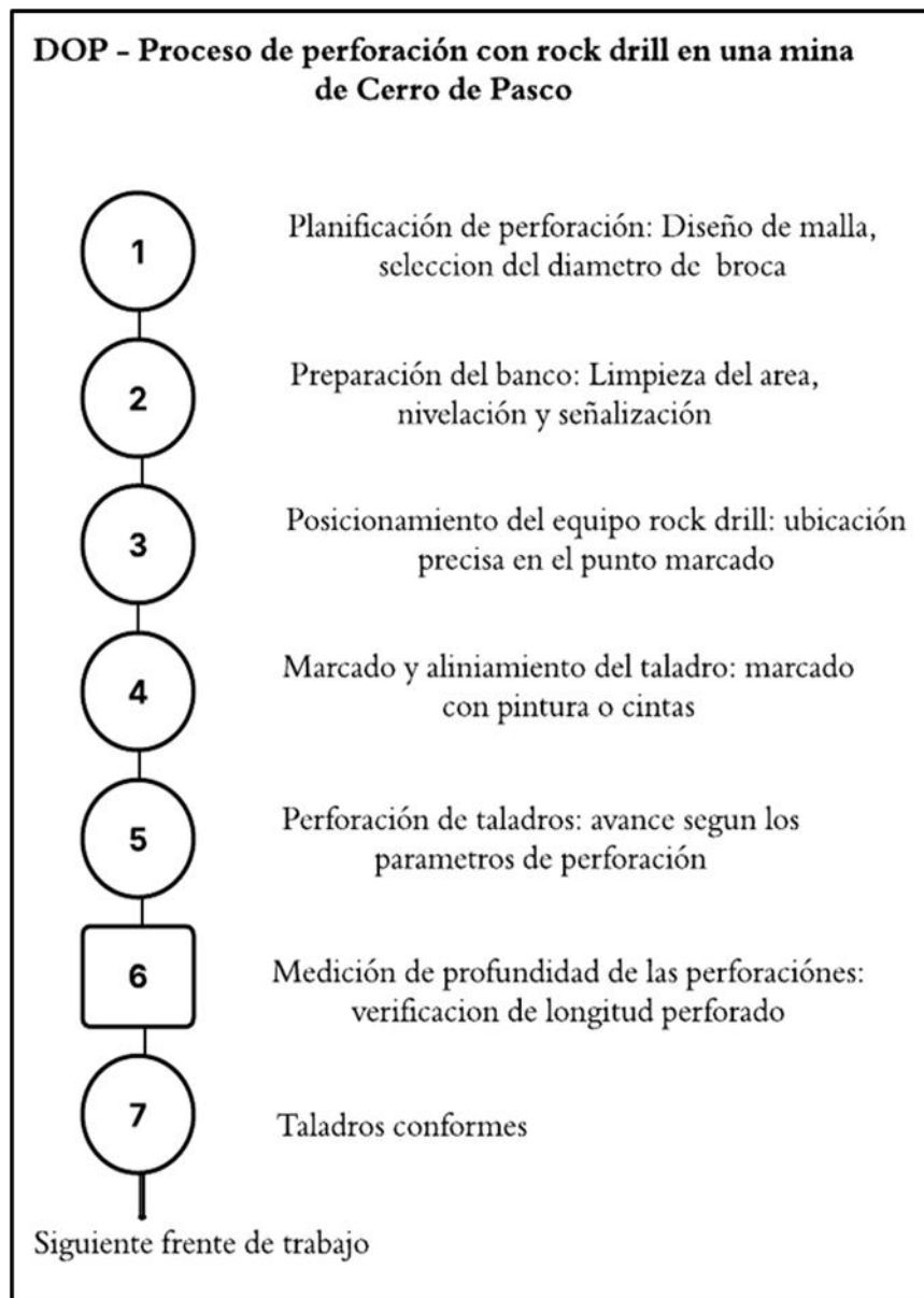
Figura 1. Diagrama de operaciones del proceso de perforación con rock drill.
