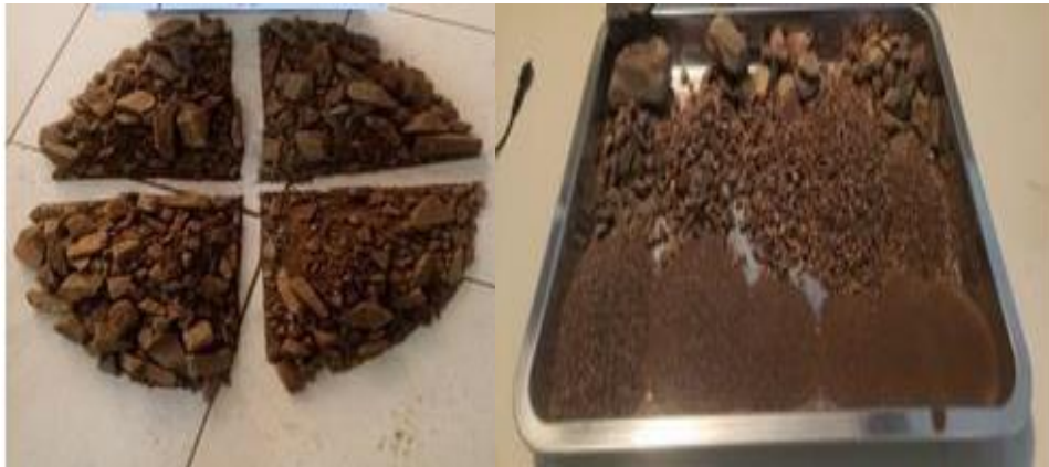
Figura 5. Cuarteo de muestra de la calicata, granulometría del tamizado.
