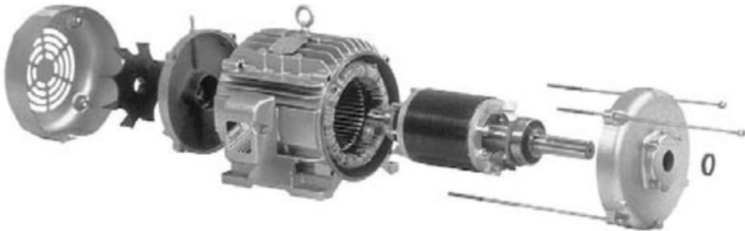
Figura 5. Vista despiezada del motor de jaula de ardilla (11)
