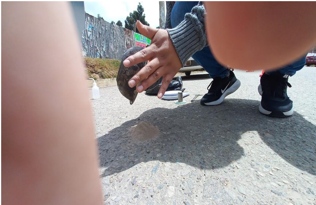
ANEXO 8 Vertido de la arena en la superficie del pavimento
