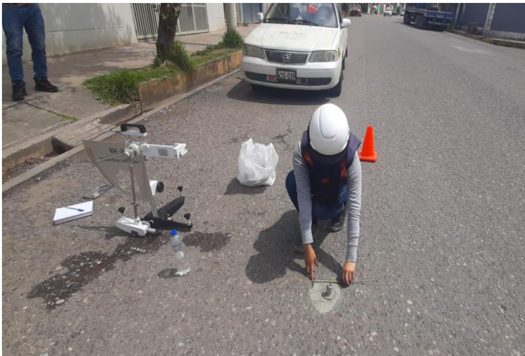
ANEXO 10 Medición del diámetro del círculo de arena
