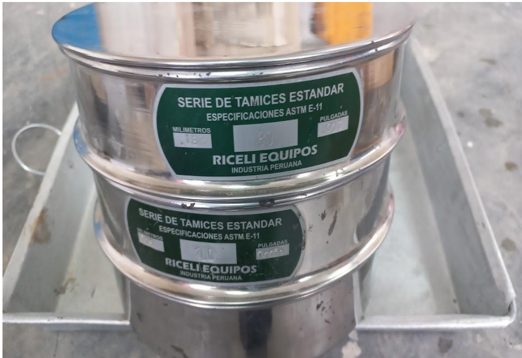
ANEXO 5 Tamiz N°80 y N°100 para material del ensayo círculo de arena
