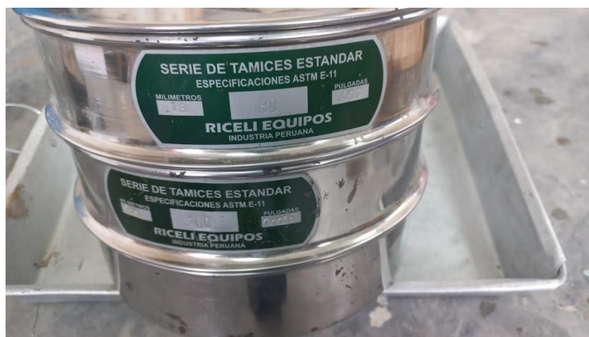
Ilustración 13 Tamiz para material de ensayo círculo de arena
