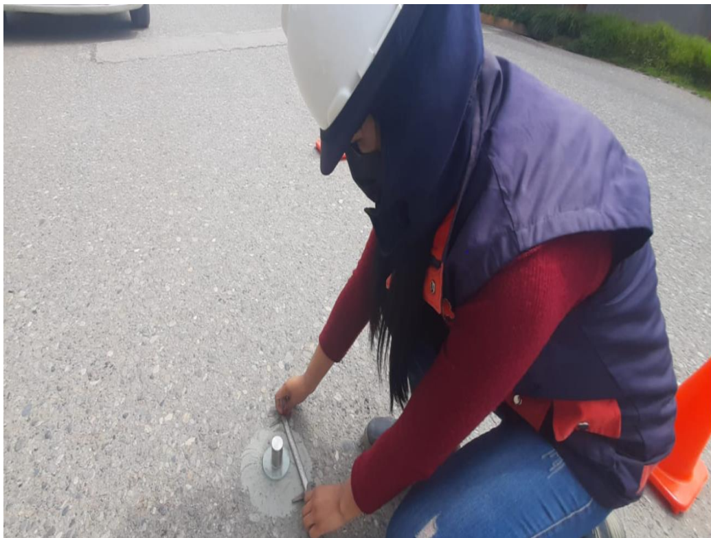
ANEXO 14 Continuando con la medición del círculo de arena
