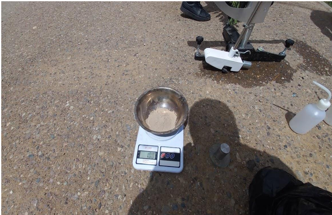
ANEXO 7 Material para el ensayo de círculo de arena
