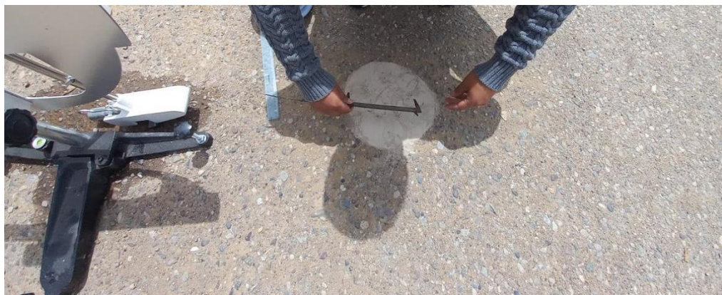
Ilustración 15 Medición del diámetro alcanzado del círculo de arena
