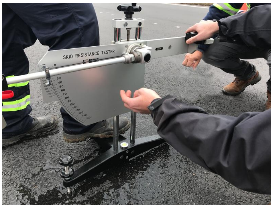
Ilustración 2 Determinación del coeficiente de resistencia al deslizamiento en el pavimento con péndulo británico (trrl)
