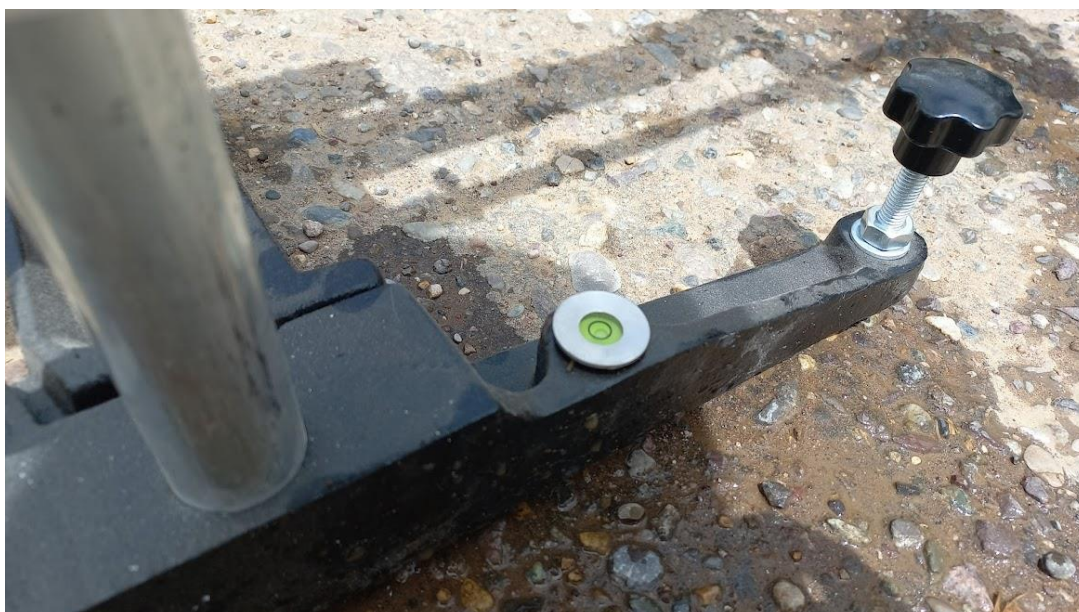
Ilustración 5 Estacionamiento del equipo de péndulo británico
