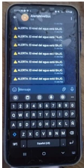
Figura 53. Notificaciones de estado de Nivel de agua mediante telegram
